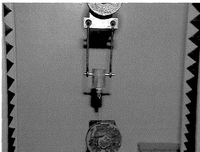
Figura 4.6 – Ensaio de remoção, por tração, em máquina Instron.
