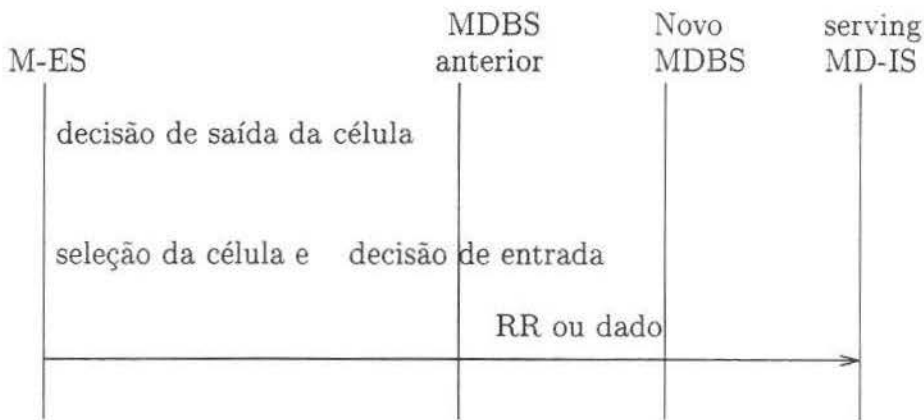
Figura 2.10: Eventos do protocolo da transferência celular intra-área
