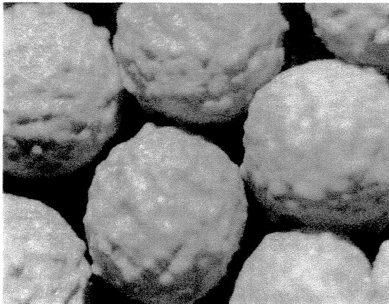
Figura 4.36 - Microscopia óptica de partículas de uréia recoberta nas condições do ensaio 09:  $W_g = 1,33 \times 10^{-2}$  kg/s,  $T_g = 50$  °C,  $P_a = 1,38 \times 10^{+5}$  Pa e  $W_c = 1,425 \times 10^{-2}$  kg/s.
