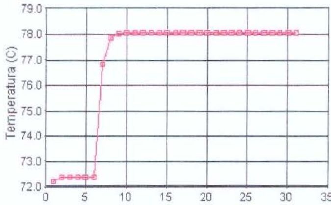
Figura VI.8 – Perfil de temperatura para a desidratação do etanol usando ciclohexano. Produto de fundo com baixa pureza de etanol.
