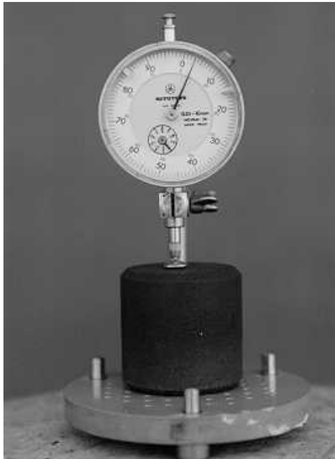
FIGURA 30 – Extensômetro utilizado nas medições de expansão e contração axial.
