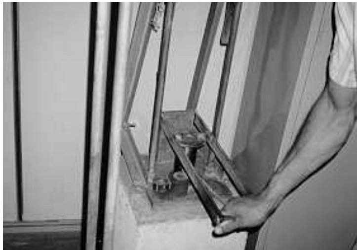
FIGURA 15 – Dispositivo de extração do corpo-de-prova.
