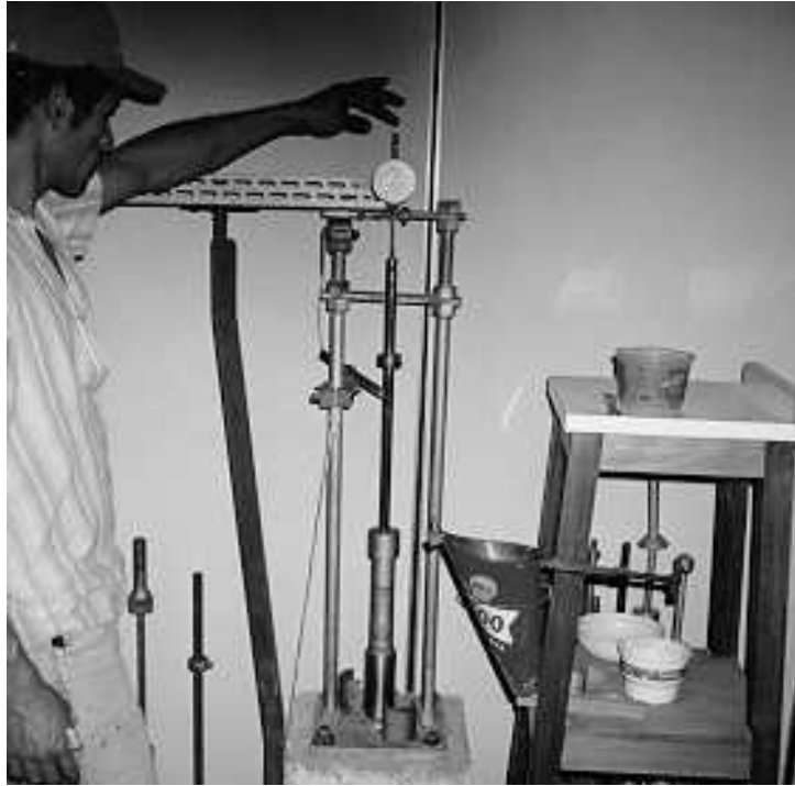
FIGURA 14 – Dispositivo de medição da altura do corpo-de-prova.
