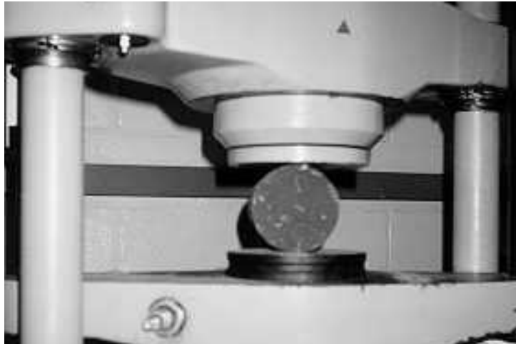
FIGURA 22 – Corpo-de-prova no ensaio de tração por compressão diametral.
