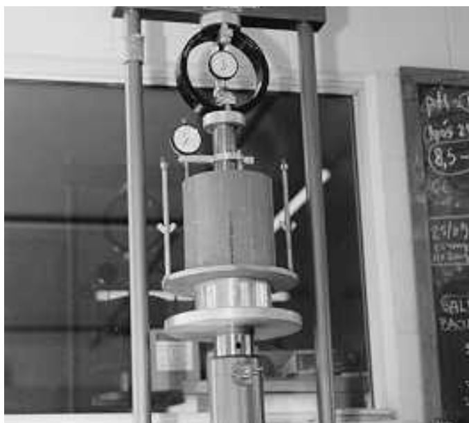
FIGURA 21 – CBR-Adaptado em operação.
