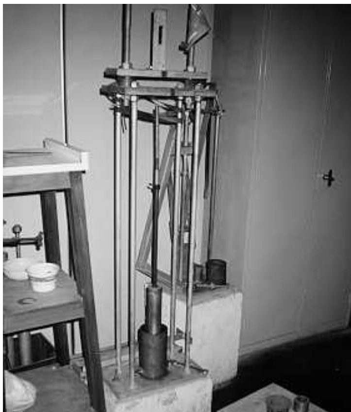
FIGURA 23 – Equipamento de compactação utilizado na confecção de corpos-de-prova para o módulo de resiliência.
