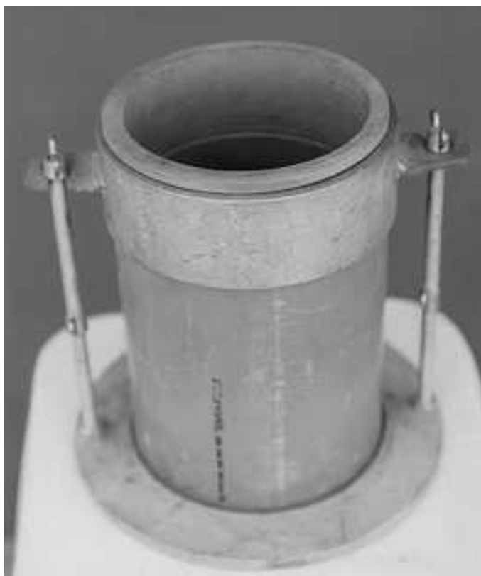
FIGURA 20 – Molde CBR-Adaptado com colar.
