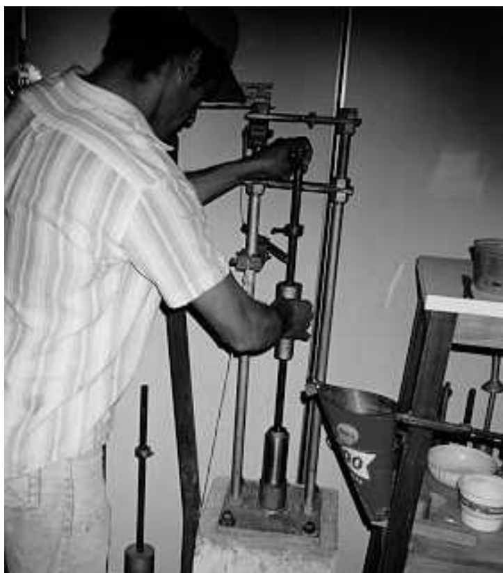
FIGURA 13 – Detalhe da compactação mini-Proctor.
