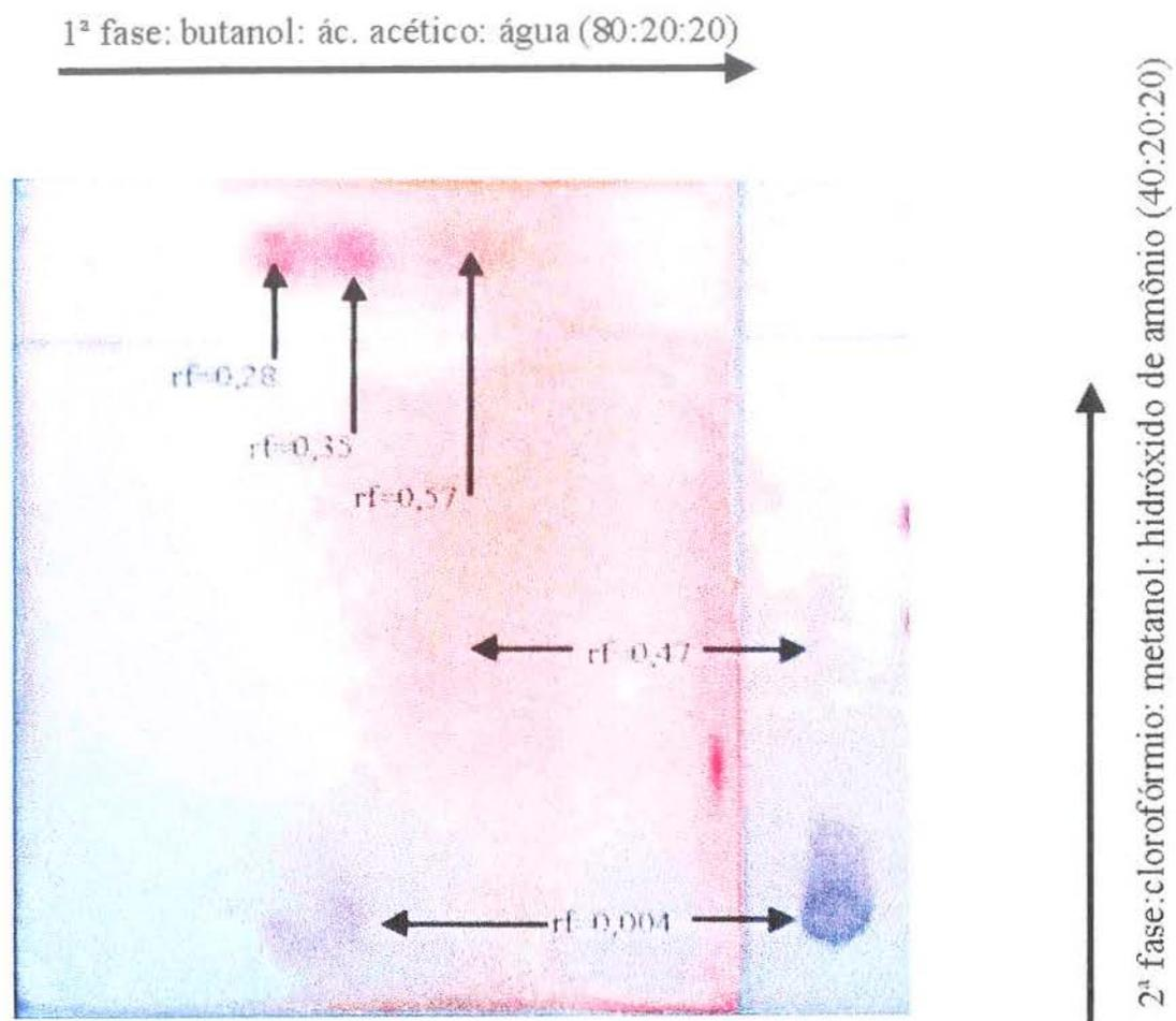
Figura 6. Cromatografia bidimensional da fração J-III em camada delgada de celulose.
