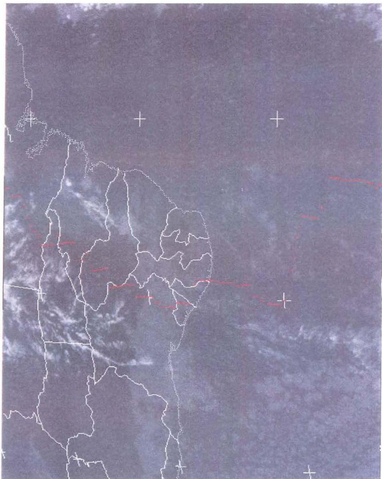
Figura 2.7: Fotomosaico pelo método de Shiren. Os pontos vermelhos são os pontos de costura horizontal para este fotomosaico (um ponto por coluna).
