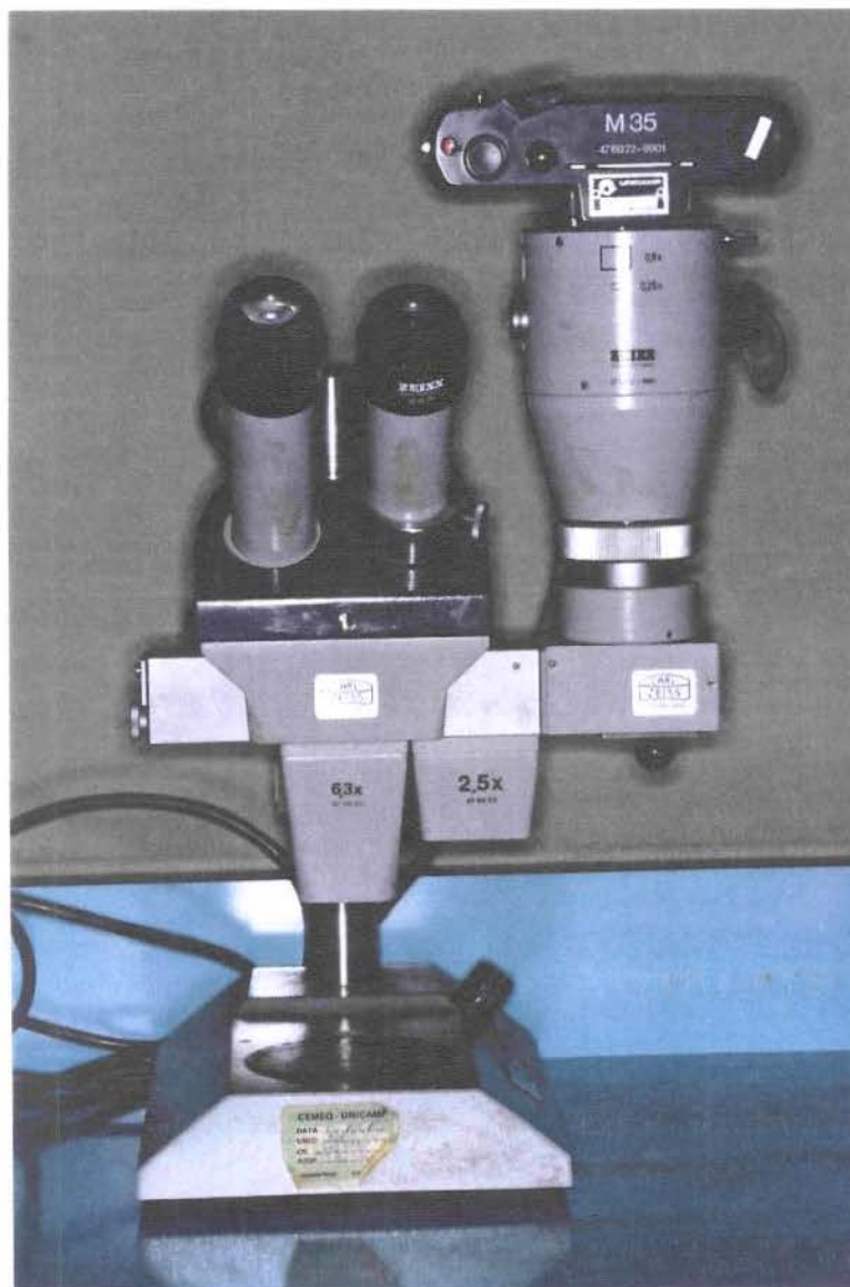
Figura 8 – Lupa estereoscópica usada no exame e fotografia dos corpos-de-prova.
