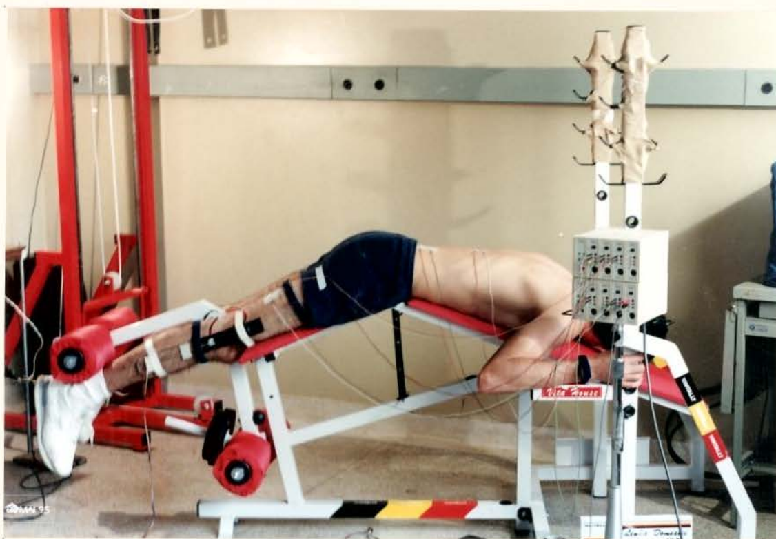
FIGURA 3 - Aparelho Vita-house na forma de mesa inclinada em que o ângulo de 138^\circ da mesa proporciona ao voluntário 42^\circ de flexão no quadril e aplanamento da lordose lombar.
