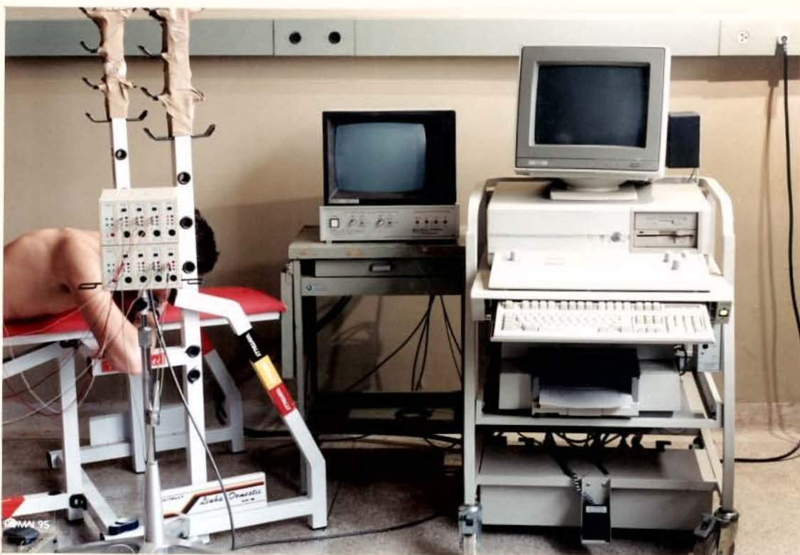
FIGURA 1 - Eletromiógrafo Nicolet - Viking II de 8 canais, com sistema automático de aquisição e análise de dados, do Departamento de Morfologia da FOP - UNICAMP.
