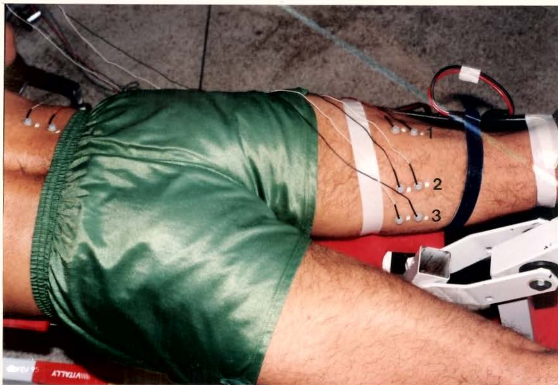
FIGURA 5. Eletrodos de superfície acoplados no membro inferior direito do voluntário: (1) m. bíceps da coxa; (2) m. semitendíneo e (3) m. semimembrâneo.
