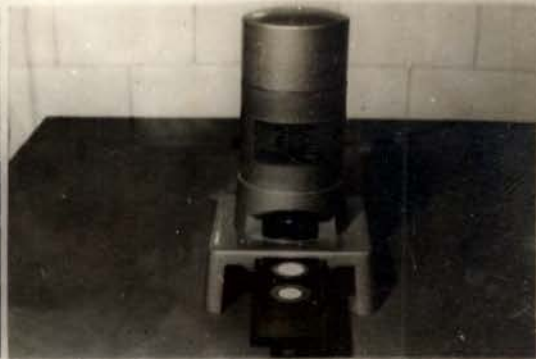
Fig. 2 CÉLULA REFLETOIRA COM CORPO DE PROVA
