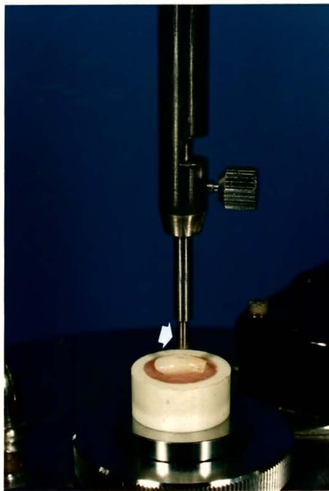
Figura 4.4 - Ponta ativa do consistômetro (seta) (X 2 linear).
