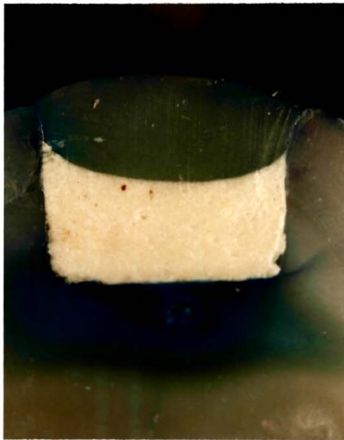
Figura 8.2 - Cimento de Fosfato de Zinco na espessura de 1 mm com carregamento axial de compressão (X 87,5 linear).
