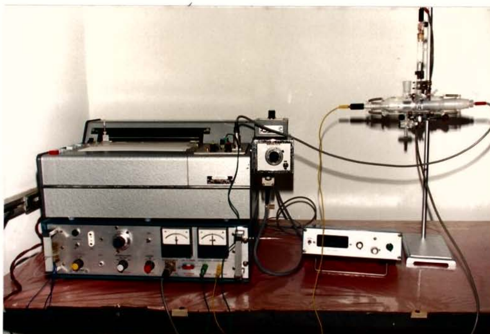
Figura 6 - Sistema de polarização (CORROSCRIPT - TUCUSSEL).
