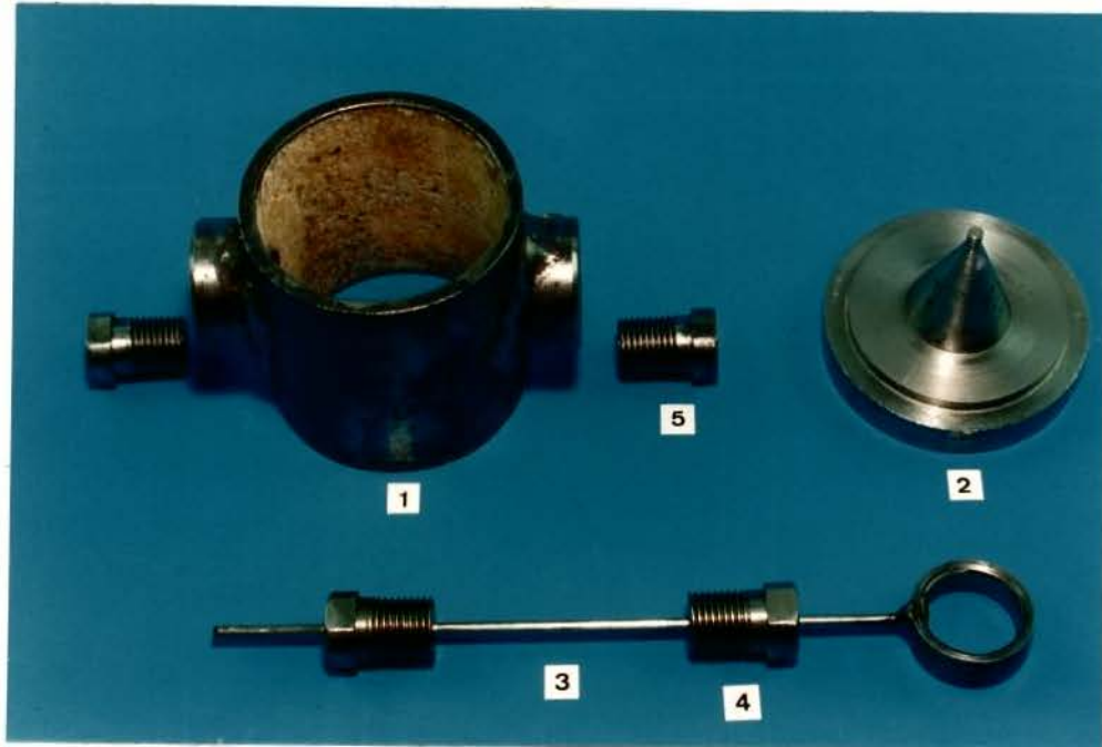
Figura 11 - Dispositivo usado na contração de fundição.
