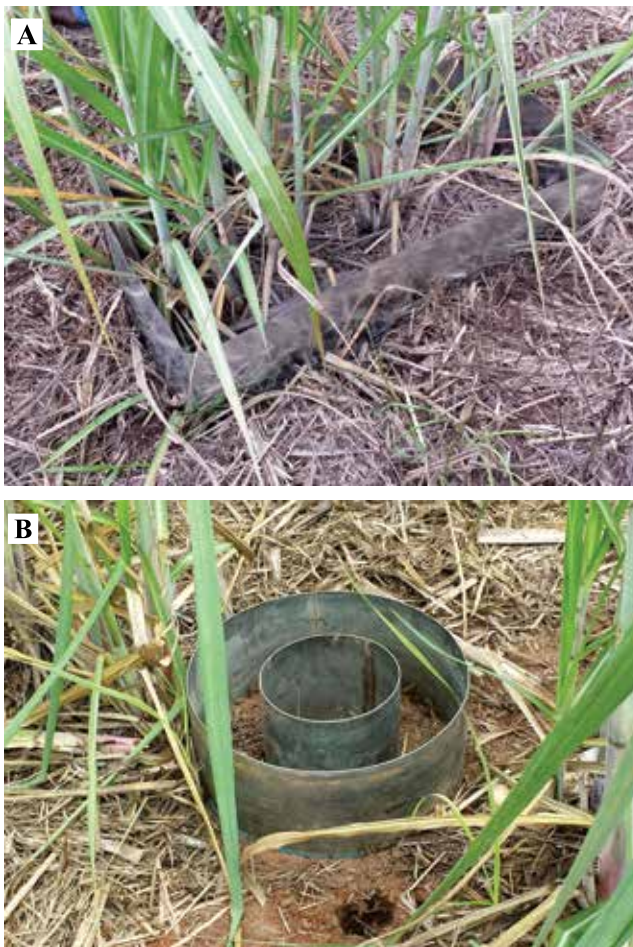
Figura 1. Experimentos realizados sob regime hídrico natural, com calhas (A), e controlado (B), com anéis concêntricos, na área de Neossolo Quartzarênico sob cultivo de cana-de-açúcar.
