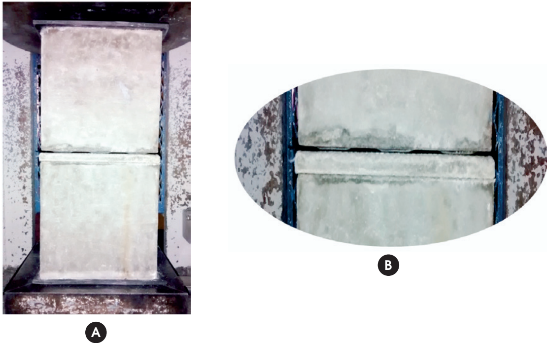
Figura 5 – a) Ensaio de transferência de tensões de compressão com bloco superior com saliências na face ligada; b) Detalhe de contato bloco-almofada-bloco
