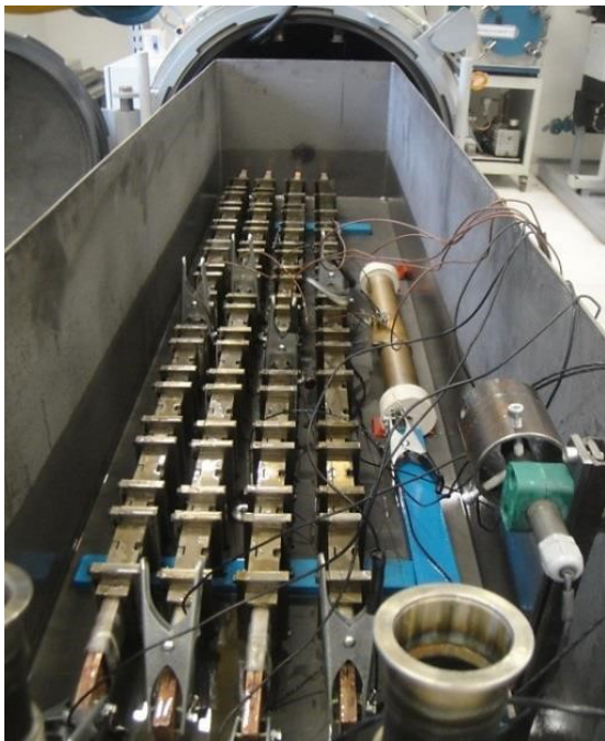
Figura 2. Banheira da autoclave com quatro barras protótipo dentro dos moldes ao fim do processo de impregnação VPI. (Cortesia Voith Hydro Ltda).
