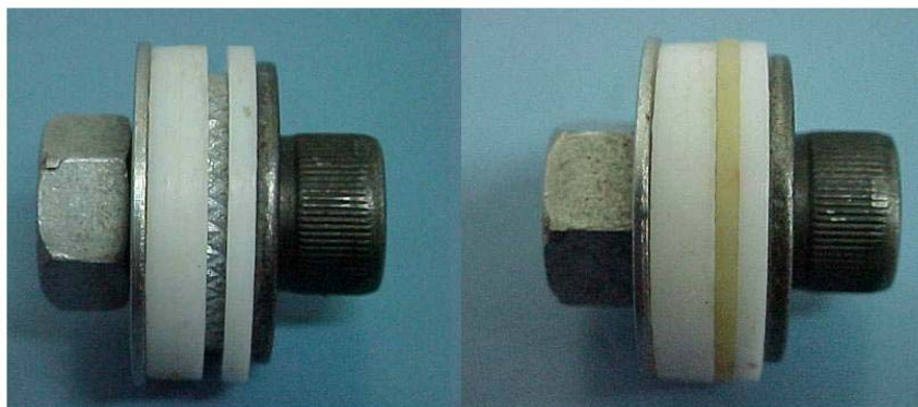
Figura 3: Matriz de teflon usada na confecção dos discos de resina.
