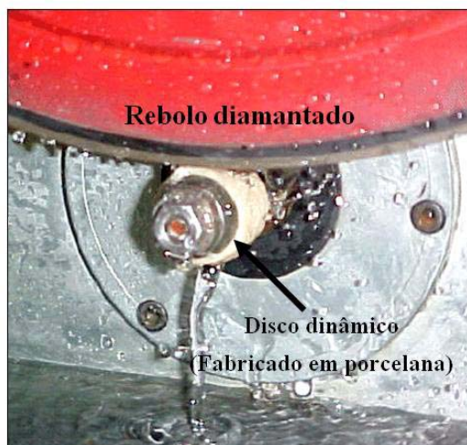
Figura 2: Detalhe da retificação do disco de porcelana. Água foi usada para a refrigeração do processo.
