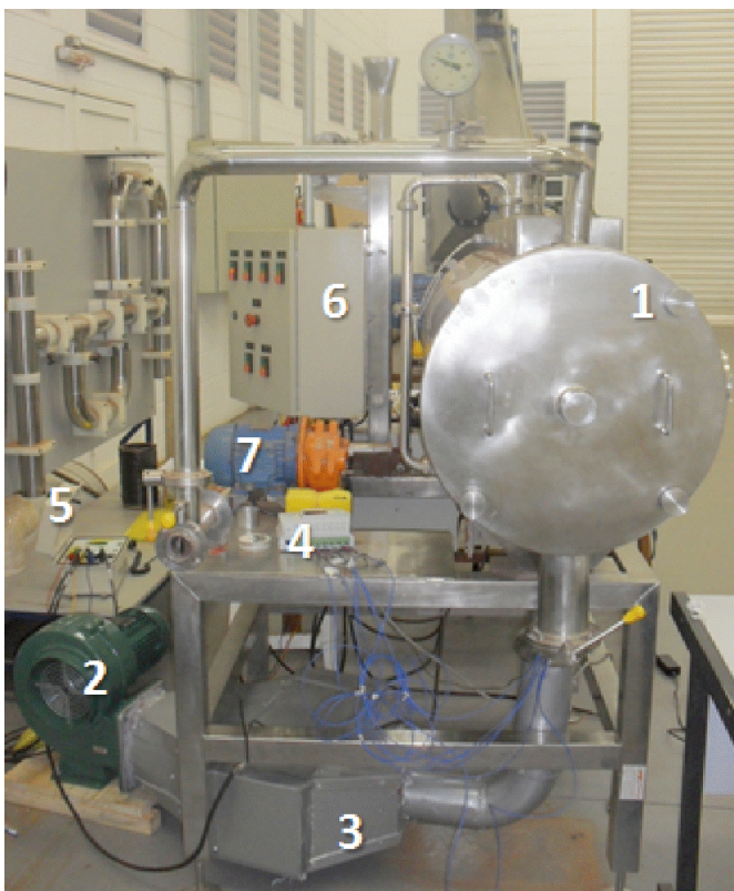
(1) Tampa da câmara de secagem; (2) Ventilador centrífugo; (3) Resistências elétricas; (4) Sistema de aquisição de dados de temperatura; (5) Medidor de energia; (6) Caixa de controle de acionamento; (7) Bomba de vácuo; (8) Corpo do secador; (9) Sistema de alimentação; (10) Movimentação de sólidos; (11) Caixa com inversor de frequência do ventilador (ABB, ACS150) e (12) Inversor de frequência do sistema de movimentação de sólidos (WEG, CFW08)
