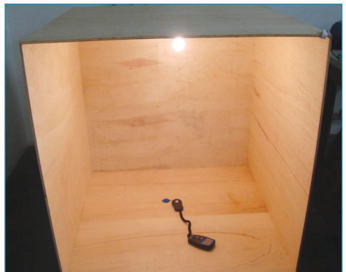
Figura 7 - Teste de luminosidade com a lâmpada LED.
