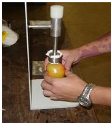
FIGURA 1. Equipamento desenvolvido para simular limpeza.
