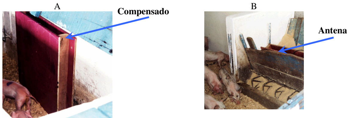
FIGURA 6. Antena-painel com a caixa de compensado localizada dentro do escamoteador (A) e disposição da antena-painel na creche dentro do comedouro (B).
