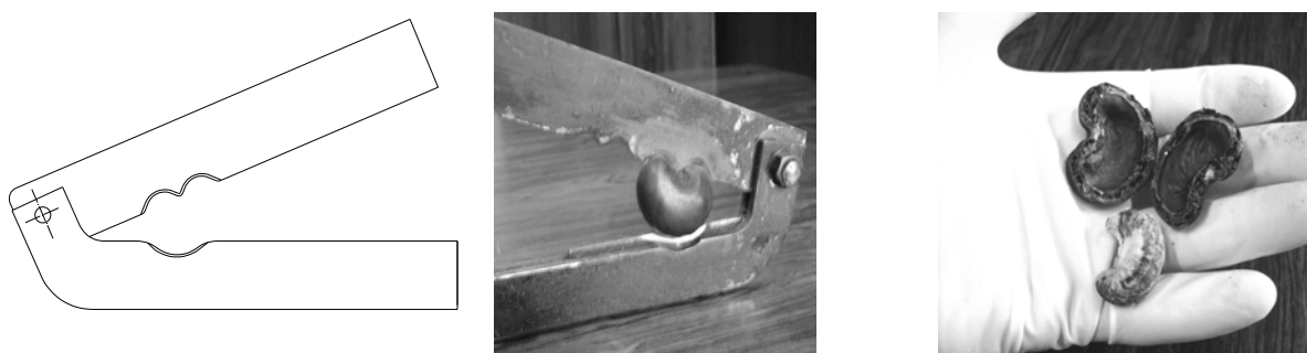
FIGURA 2. Vistas do dispositivo, projetado e construído para a decorticação manual das castanhas de caju, por meio de lâminas afiadas, e castanha aberta sem danos à amêndoa. Device specially designed to cut open the nut shell using sharp blades in order to extract the kernel with no damage.
