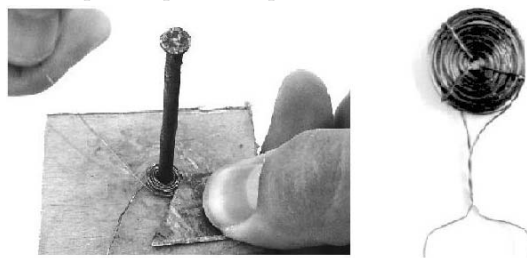
Figura 3 - Construção da espiral.
