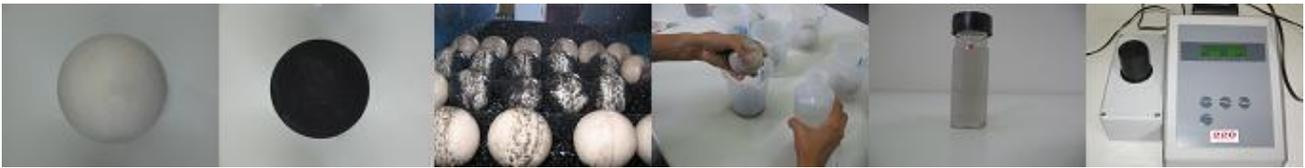
FIGURA 4. Etapas para a determinação do índice de limpeza: esfera limpa, esfera suja, esferas no protótipo, lavagem manual/individual das esferas após a passarem pelo protótipo, amostra da água de limpeza e turbidímetro de bancada. **Steps for determining cleaning efficiency: clean sphere, dirty sphere, spheres on the prototype, hand washing / personal spheres after passing through prototype, cleaning water sample and bench turbidimeter.**
