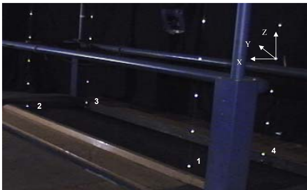
Figura 2. Demarcação tridimensional do ambiente de filmagem do qual se visualizam os quatro calibradores (1, 2, 3 e 4) e seus marcadores dispostos verticalmente sobre a esteira rolante. Um sistema de coordenadas está representado sobre um dos marcadores.
