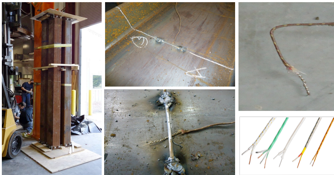
Figura 10 - Termopares de registro de temperatura no elemento ensaiado
