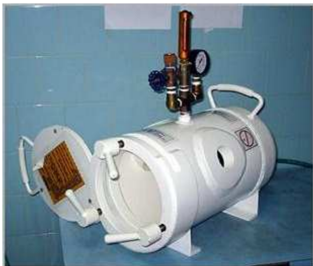
Figura 2 - Câmara hiperbárica (CHV - Vitória Montadora e distribuidora Ltda- Vitória-ES) com formato cilindro capsular construída com aço carbono: 1 - Entrada e saída da câmara; 2 - Válvula para escape do oxigênio; 3 - Termômetro; 4 - Manômetro; 5 - Tubo para entrada de oxigênio no interior da câmara; 6 - Visor para observação dos animais no interior da câmara; 7 - Tampa oclusora da câmara. A Câmara tem 27 cm de largura, 51 cm de comprimento e 1,5 cm de espessura.
