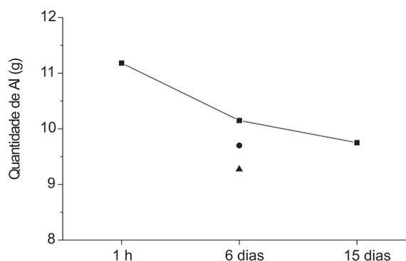
Figura 1. Quantidade de alumínio incorporado em função da concentração da suspensão e do tempo de envelhecimento da solução pilarizante (▲ =  $1 \text{ g}/0 \text{ mL}$ ; ● =  $1 \text{ g}/15 \text{ mL}$ ; ■ =  $1 \text{ g}/100 \text{ mL}$ )
