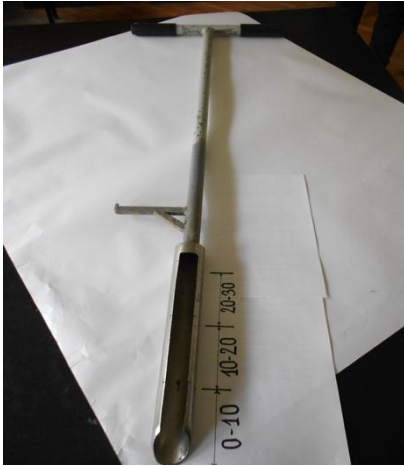
Slika 6. Sonda za uzorkovanje zemljišta
