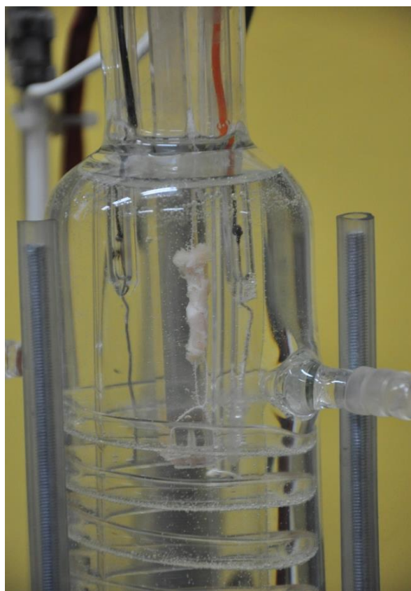
Слика 7. Приказ препарата ампуле монтираног у купатилу
