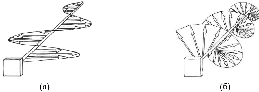
Слика 2.2. Поларизација антене (а) Линијска поларизација антене (б) Кружна поларизација антене
