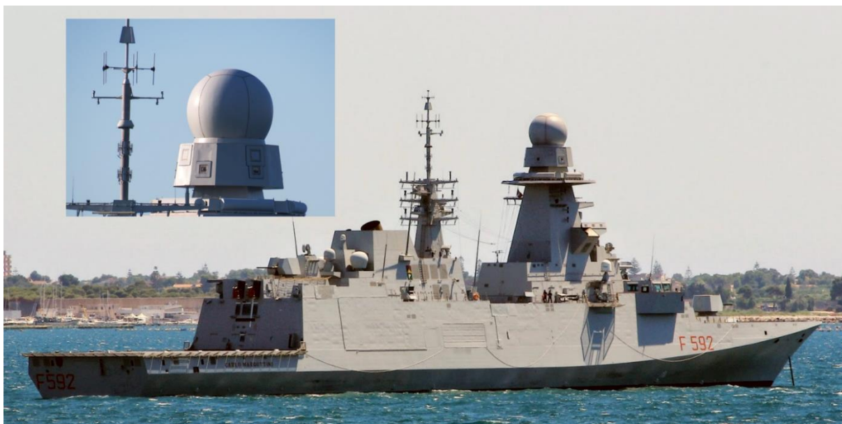
Слика 3.1. Фрегата Bergamini са увеличаном Thales Altesse-C DF-ом [69]
