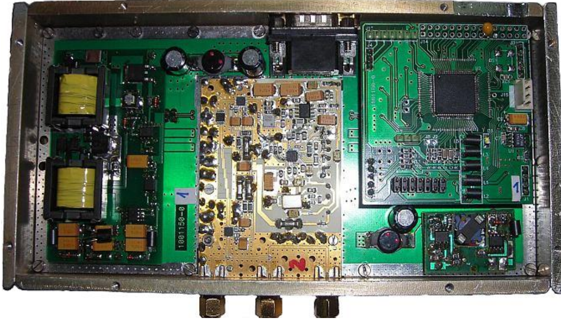
Слика 8.10. ВВ плоча са микс-сигнал процесорском јединицом
