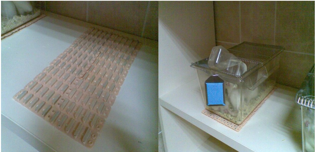
Slika 2. Prikaz izvora stalnog magnetnog polja u laboratoriji. Šest komada spojenih magnetnih traka (panel levo). Kavez sa spontano hipertenzivnim pacovima na magnetnim trakama (panel desno).
