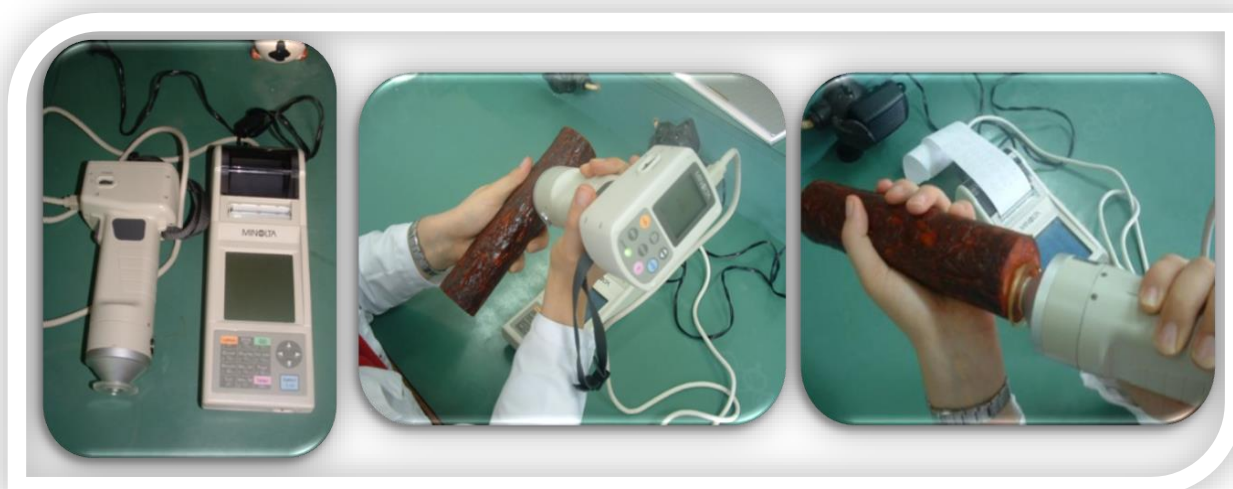
Slika 4.4. Instrumentalno određivanje boje uzorka Petrovačkih kobasica
