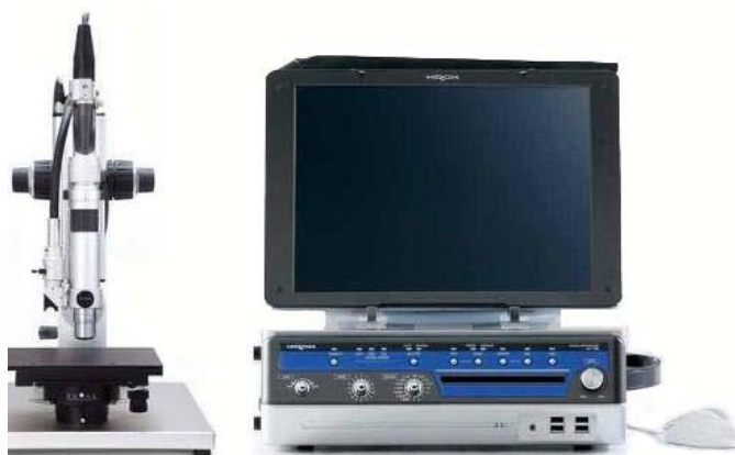
Slika 4.6: 3D mikroskop HIROX KH-7700
