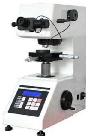
Slika 4.7: Uređaj za merenje mikrotvrdoće metodom Vickers TH710
