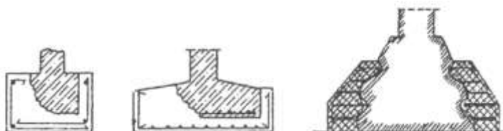
Сл. 4.7 – Ојачавање оштећења стопа. Извор: 116)
