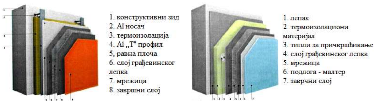
Сл. 5.10 – Детаљи вишеслојног термоизолационог система са завршном обрадом. Извор: http://www.sendflowers4.info/stoventec-52cc802/
