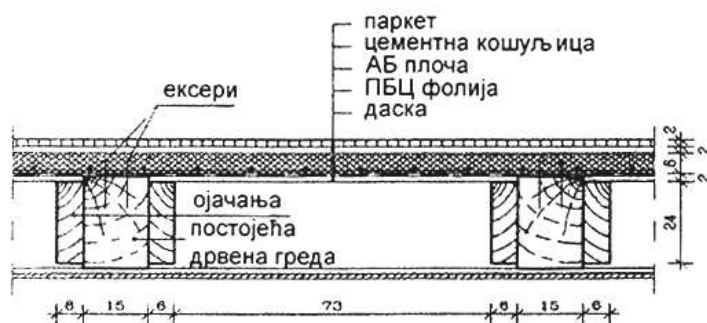
Сл. 4.32 – Детаљ попречног пресека саниране дрвене међуспратне конструкције са гредама ојачаним дрвеним образним елементима. Извор: http://beobuild.rs
