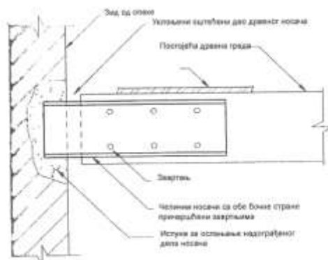
Сл. 4.48 – Надоградња оштећеног дрвеног носача челичним профилем са обе бочне стране. Извор: https://www.gradnja.rs
