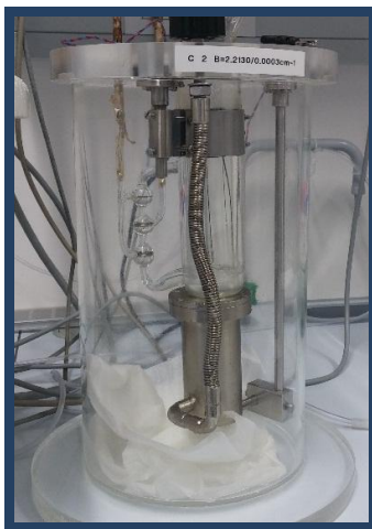
Slika 3.7. Troelektrodna ćelija za merenje provodljivosti razblaženih vodenih rastvora
