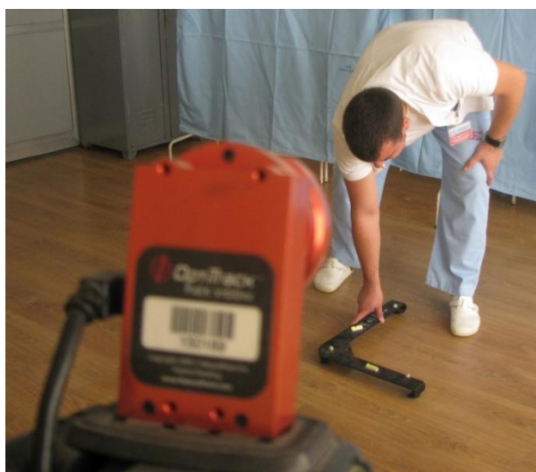
Слика 26. Формирање координатног система запремине снимања
