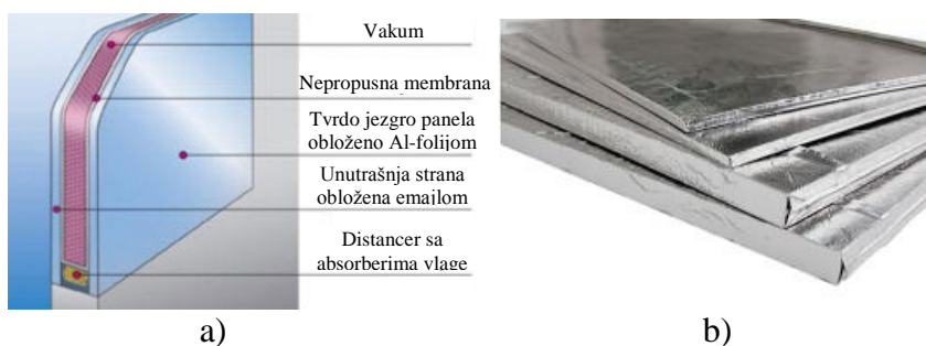
Slika 61 Panel sa vakumskom izolacijom (VIP); a) struktura, b) izgled
