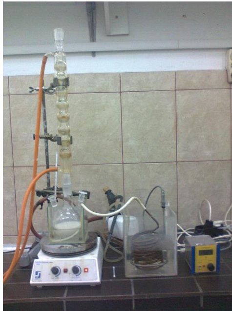
Slika 8.1 Eksperimentalno postrojenje za kiselo-katalizovanu esterifikaciju SMK ulja konoplje i bazno-katalizovanu metanolizu esterifikovanog ulja
