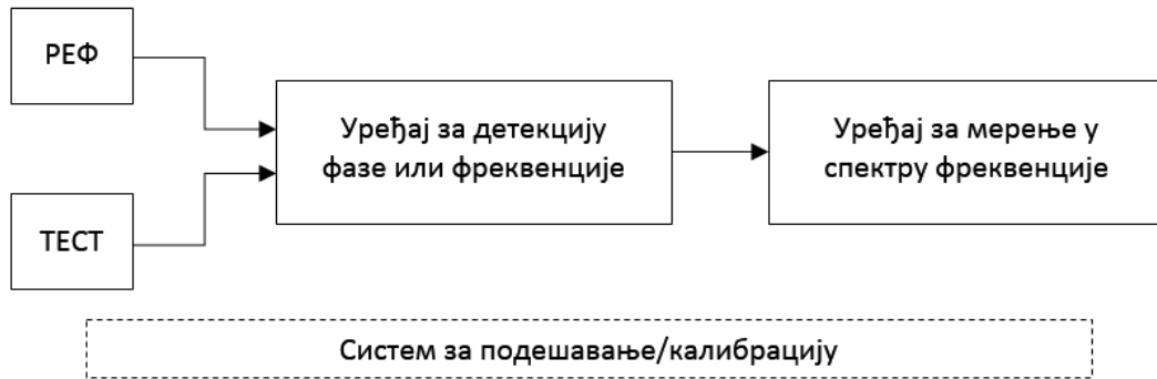
Слика 18: Основни принцип система за мерење фазног шума
