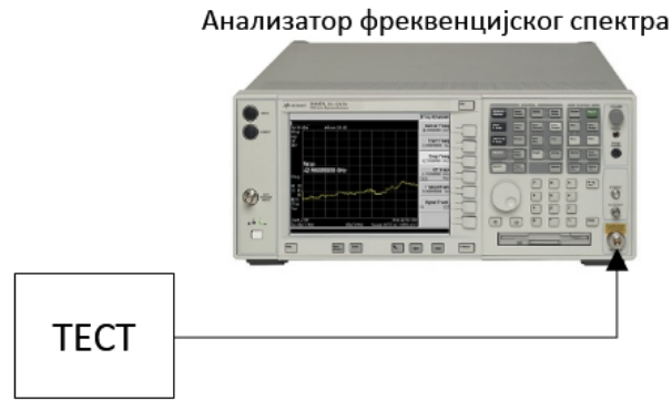
Слика 19: Директно мерење фазног шума помоћу анализатора фреквенцијског спектра
