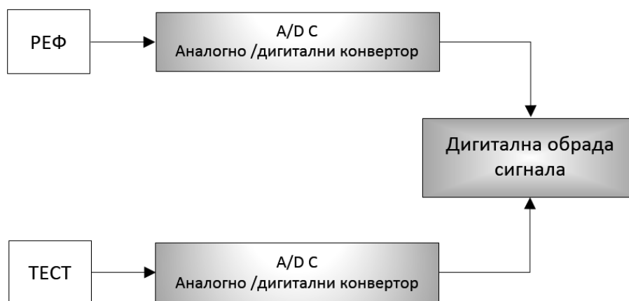
Слика 41: Концепт директног дигиталном мерења фазног шума, одабирањем сигнала на носећој фреквенцији
