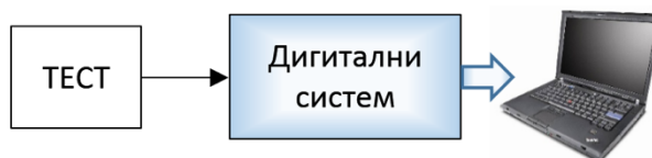
Слика 29: Блок шема директног дигиталног мерења фазног шума, за случај ниских носећих фреквенција ТЕСТ сигнала
