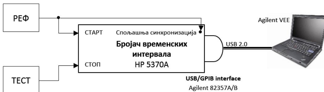
Слика 33: Блок дијаграм реализоване директне методе мерења помоћу бројача временског интервала
