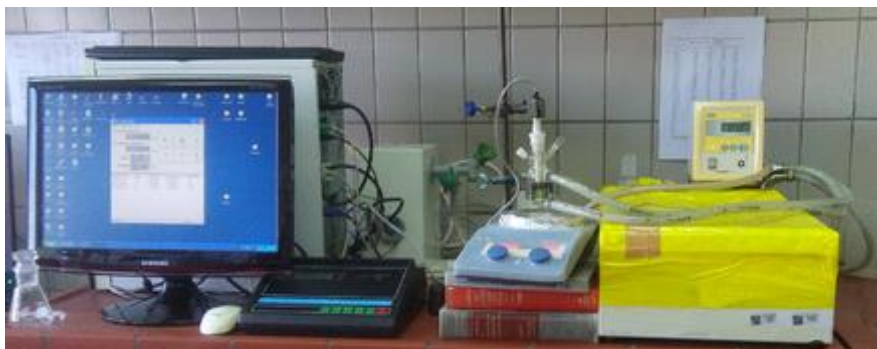
Slika 3.13. Aparatura za konduktometrijsko merenje
