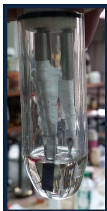
Slika 3.23. Pripremljena troelektrodna ćelija
