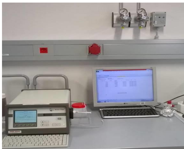
Slika 3.1. Automatski denzimetar Anton Paar DMA 5000
