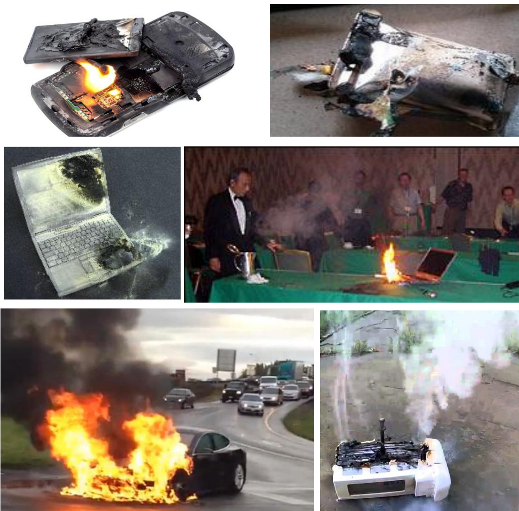
Slika 2.40. Akcidenti nastali usled nestabilnosti elektrolita i zapaljivosti litijum-jonske baterije
