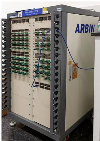
Slika 3.24. Galvanostat Arbin 2042 Battery Test System
