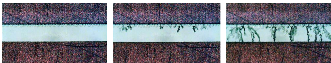
Slika 2.26. Rast dendrita na anodi
