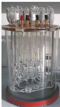
Slika 3.9. Sklop od devet ćelija za simultano merenje provodljivosti koncentrovanih rastvora
