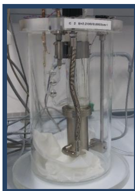
Slika 3.11. Troelektrodna ćelija za merenje provodljivosti razblaženih rastvora
