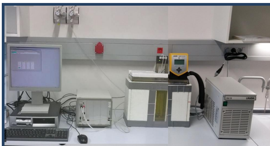
Slika 3.5. Aparatura za merenje viskoznosti
