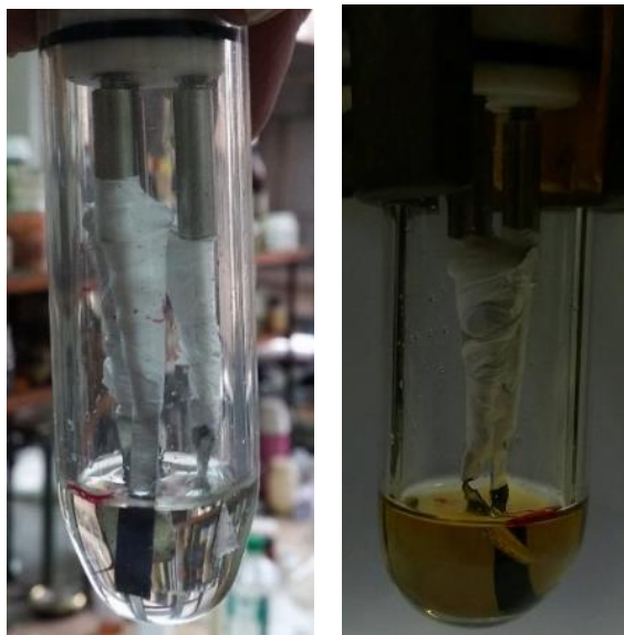
Slika 4.61. Izgled elektrohemijske ćelije: a) pre i b) posle elektrohemijskih eksperimenata
