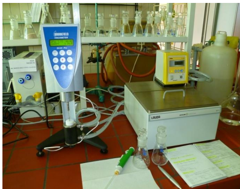
Slika 3.8. Aparatura za merenje viskoznosti
