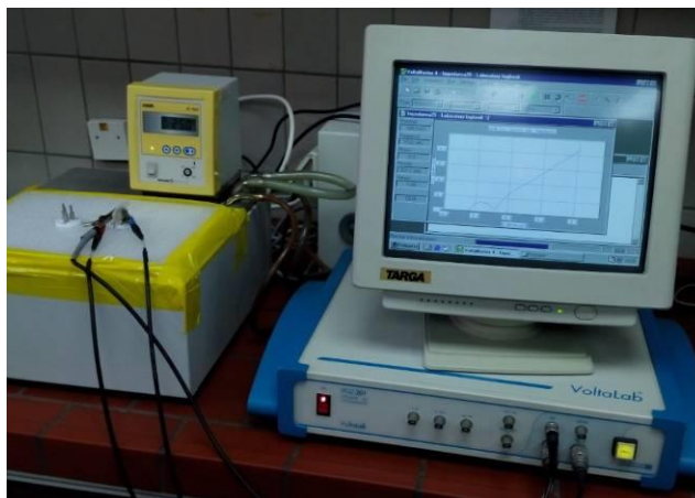
Slika 3.25. Volta Lab uređaj za izvođenje ciklovoltametrijskih eksperimenata
