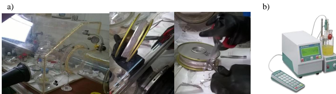
Slika 3.22. a) Glove box, sečenje litijumske metalne folije i b) Karl-Fischer-ov titrator
