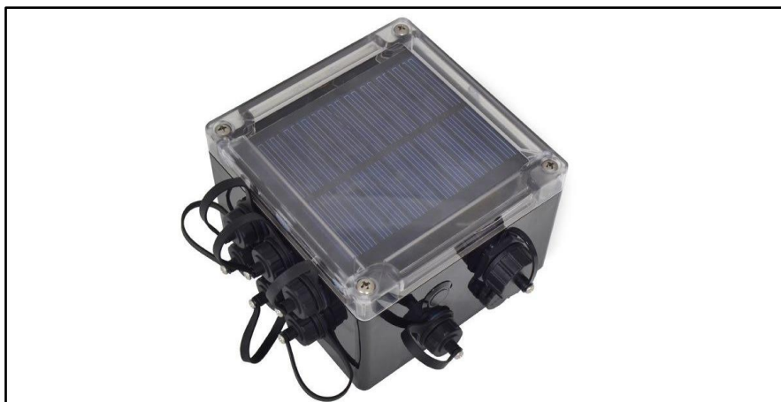
Slika 4.23 Zbog kvadratnog oblika solarnog panela, poželjni oblik projektovanog bežičnog senzorskog čvora je u obliku kocke [85]
