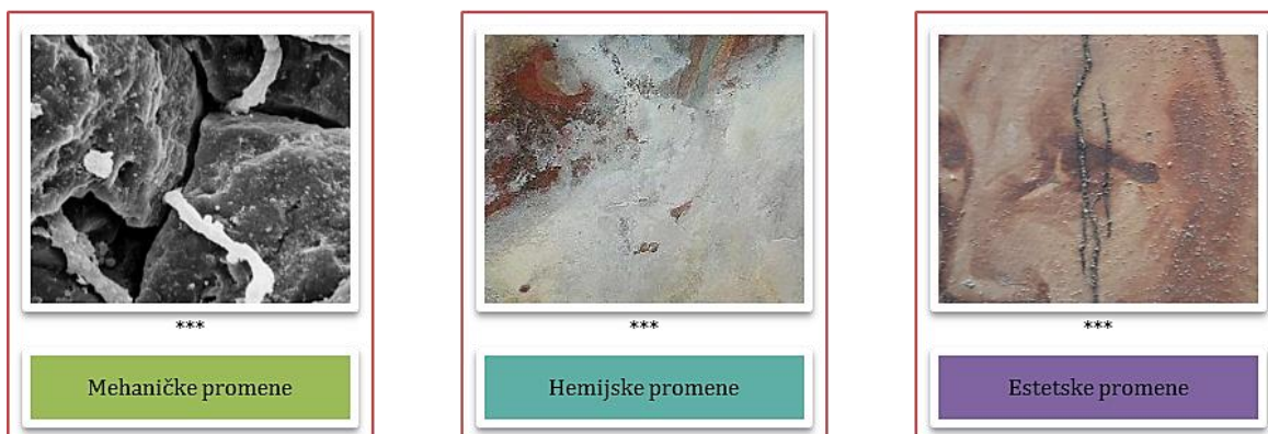
Slika 9. Promene na zidnim slikama uzrokovane rastom i produktima metabolizma mikromiceta
