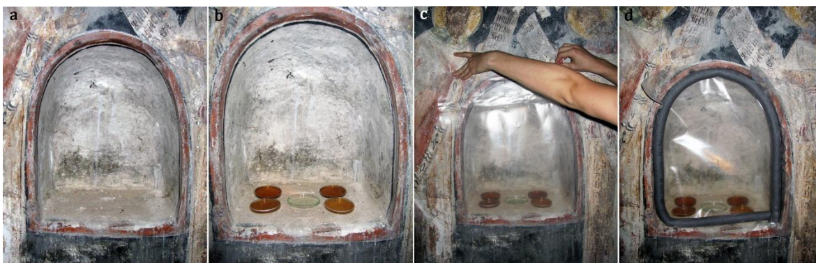
Slika 37. Testiranje antifungalne aktivnosti etarskog ulja Boswellia carteri u đakonikonu crkve: a. udubljenje u zidu naosa - đakonikon; b-c. priprema aromatične komore; d. eksperiment isparavanje etarskog ulja in situ
