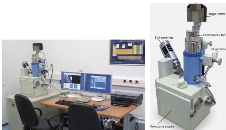
Слика 5.2: SEM модел: JEOL JSM-6610LV, коришћен у испитивањима у оквиру дисертације.
