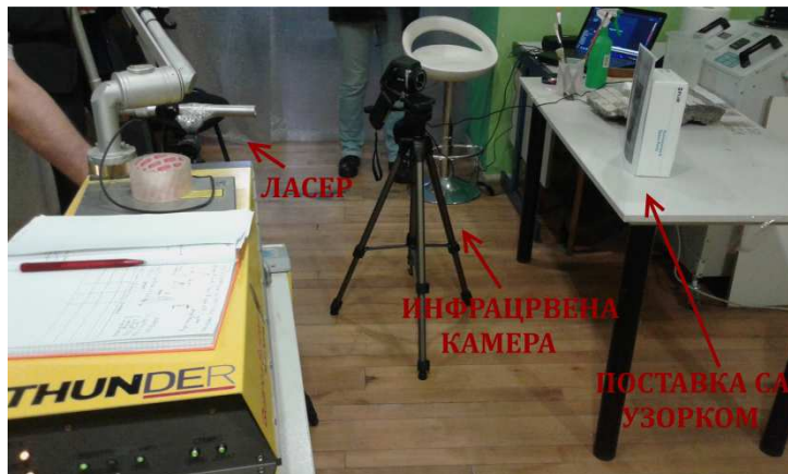
Слика 7.21: Експериментална поставка термографског испитивања на узорку озрачаваном ласером у Централном институту за конзервацију у Београду
