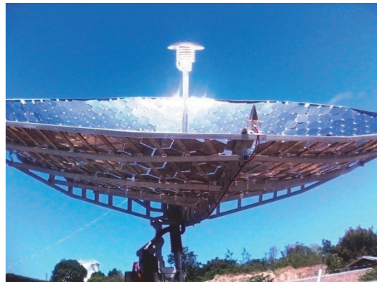
Слика 4.7. 3D модел параболичног концентришућег пријемника са равним шестоугаоним фасетама (лево); основа концентратора - параболоид ( D=5\text{m} , f=1.6\text{m} )
