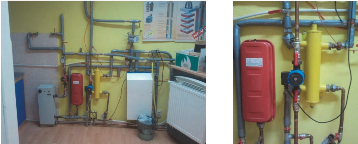
Слика 7.6. Испитна инсталација за спољашње испитивање са затвореним циркулационим колом – елементи инсталације у унутрашњости лабораторије
