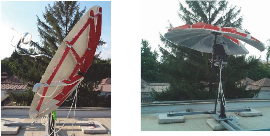
Слика 7.2. Соларни концентришући систем у радном и сигурносном положају
