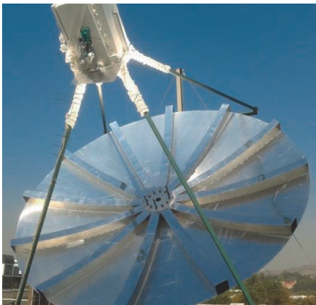
Слика 4.4. Реални систем (лево), 3D модел соларног параболичног пријемника са системом двоног праћења сунца (десно)
