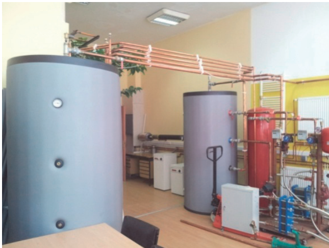
Слика 7.9. Изведена инсталација са акумулаторима топлотне енергије у оквиру експерименталног лабораторијског система и Pt 500 сонда за мерење температуре
