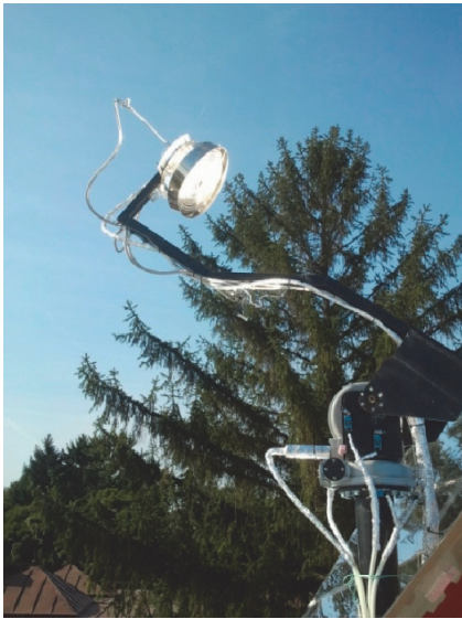
Слика 7.7. Концентрисање рефлектованог сунчевог зрачења у спиралном набораном топлотном апсорберу
