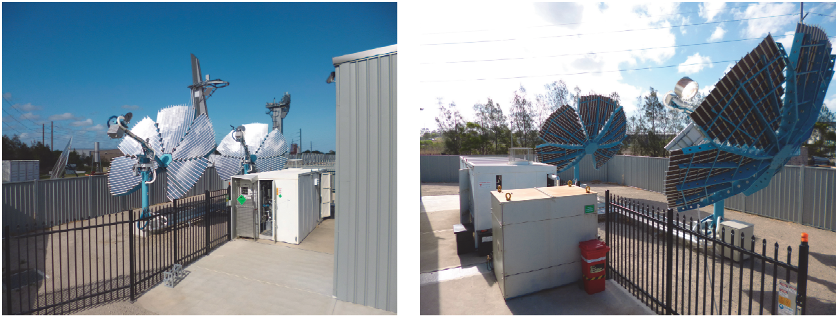
Слика 2.29. Параболични концентратор сунчевог зрачења са аспсорпционим чилером SASCs - испитна станица - CSIRO Energy Centre смештен у Њукастлу, NSW [26]
