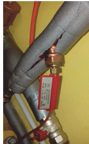
Слика 7.9. Изведена инсталација са акумулаторима топлотне енергије у оквиру експерименталног лабораторијског система и Pt 500 сонда за мерење температуре
