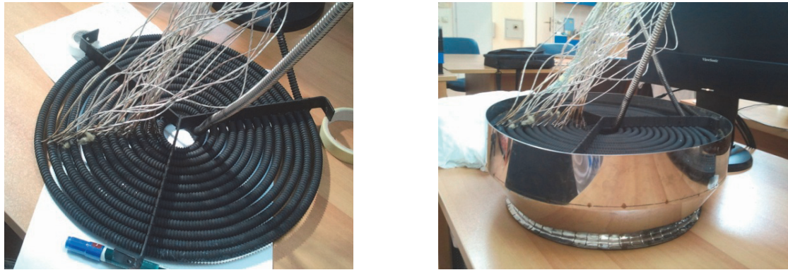
Слика 7.11. Аксијално позиционирање мерних крајева термопарова дуж истог радијалног правца спиралног апсорбера
