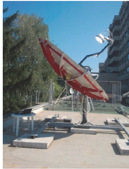
Слика 7.7. Концентрисање рефлектованог сунчевог зрачења у спиралном набораном топлотном апсорберу
