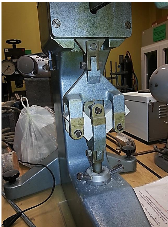
Слика 4.64 – Лом епрувете облика призме након наношења оптерећења
