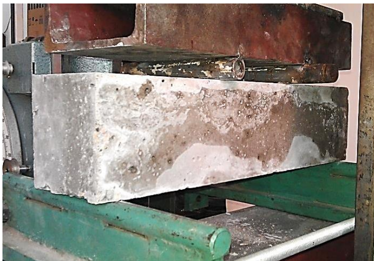
Слика 4.51 – Епрувета облика призме пре наношења оптерећења
