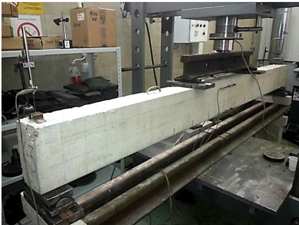
Слика 5.13 – Експериментални модел К-3 пре наносења оптерећења
