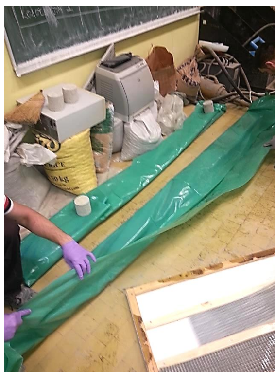
Слика 4.38 – Умотавање фероцементних елемената у најлон
