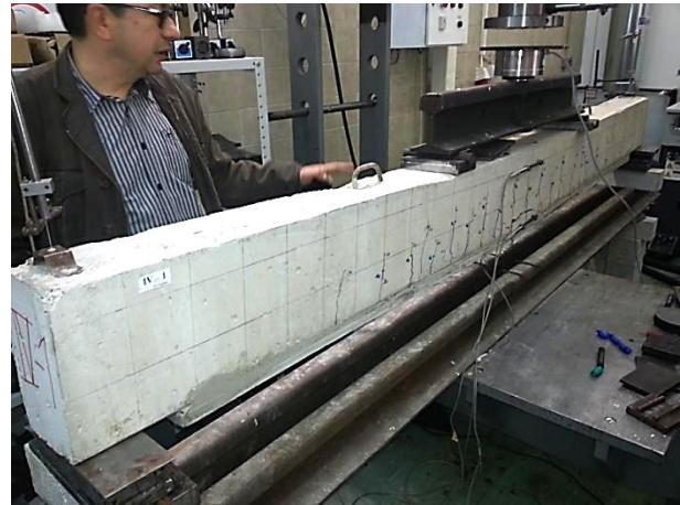
Слика 5.90 – Експериментални модел IV-1 пре доношења оптерећења Слика 5.91 – Експериментални модел IV-1 након фазе лома
