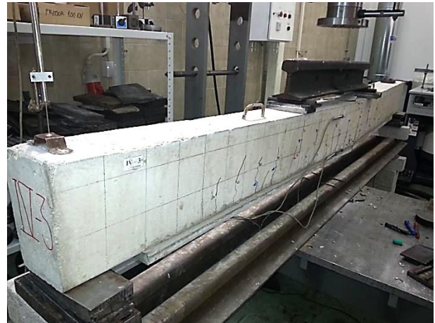
Слика 5.105 – Експериментални модел IV-3 након фазе лома
