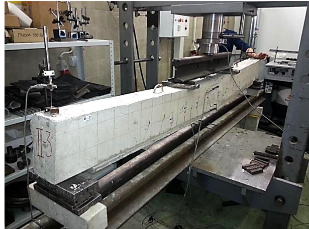
Слика 5.59 – Експериментални модел П-3 након фазе лома
