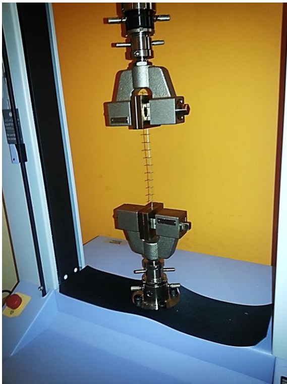
Слика 4.66 – Испитивање узорака појединачних жица на кидалици
