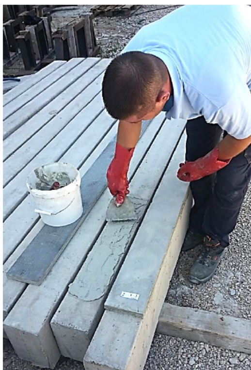
Слика 4.76 – Наношење епокси-малтера на АБ греду
