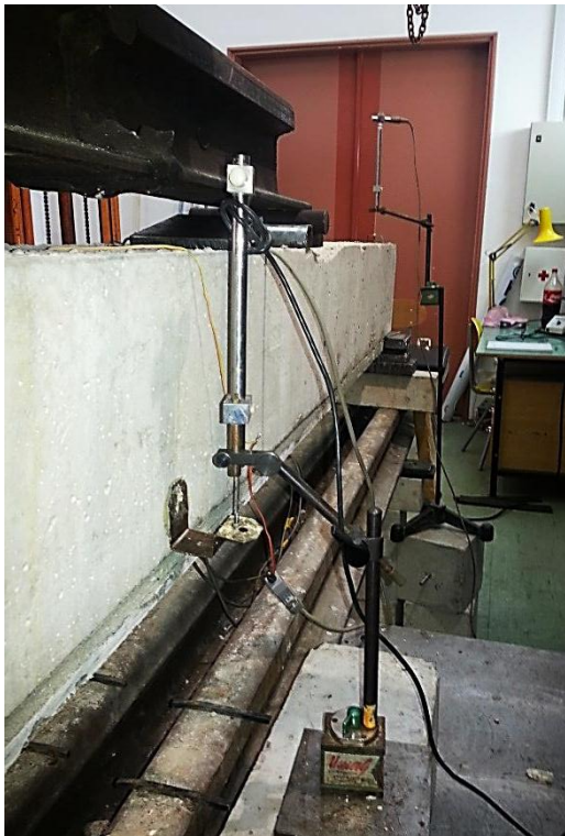
Слика 4.83 – Положај угибомера U_1 у половини распона носача
