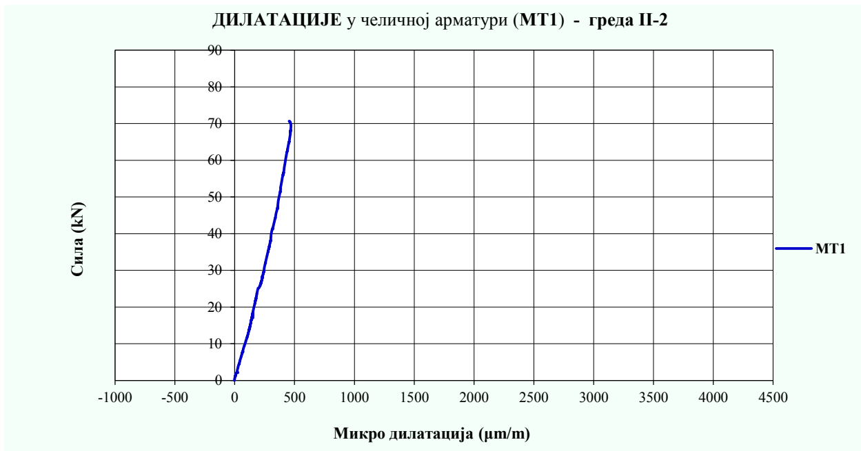
Слика 5.56 – Дилатације у челичној арматури модела II-2, мерене на MT1
