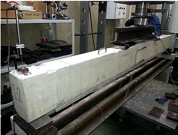
Слика 5.28 – Експериментални модел I-2 пре доношења оптерећења
