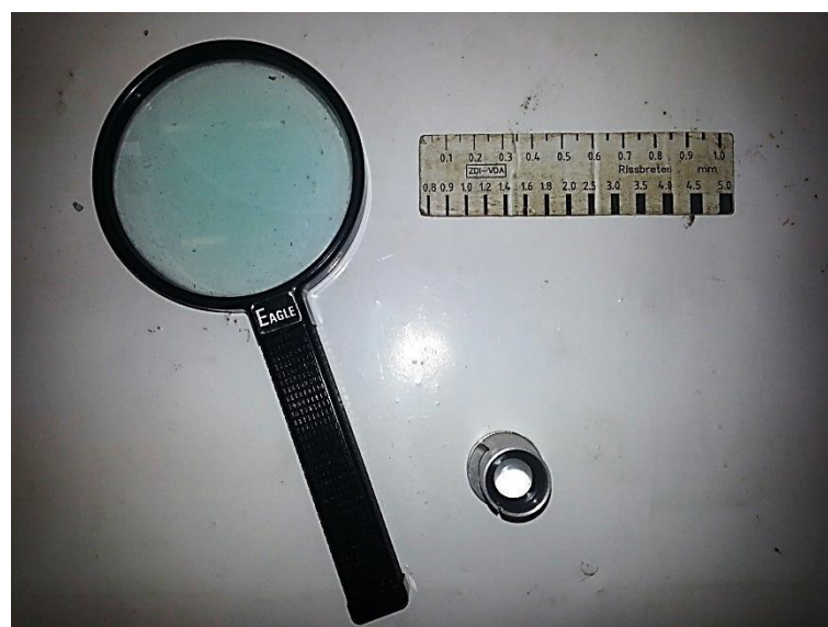
Слика 4.91 – Прибор за визуално праћење прслина
