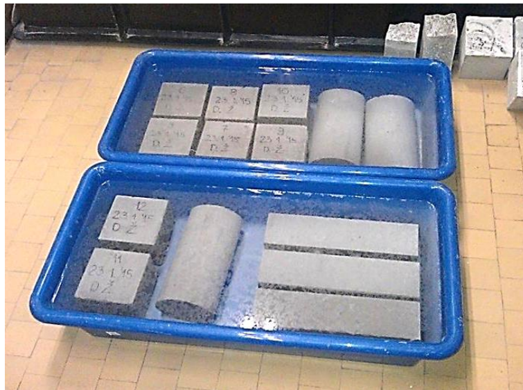
Слика 4.47 – Нега пробних узорака (епрувета) у води пре испитивања
