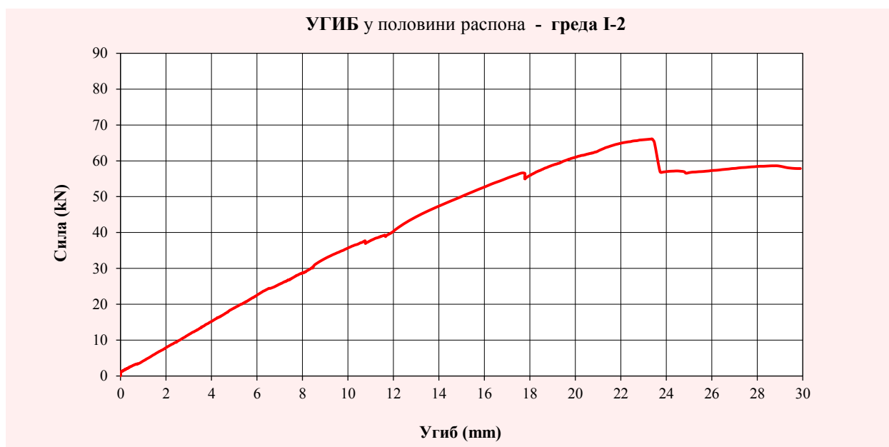
Слика 5.31 – Дијаграм угиба, мерених у половини распона модела I-2
