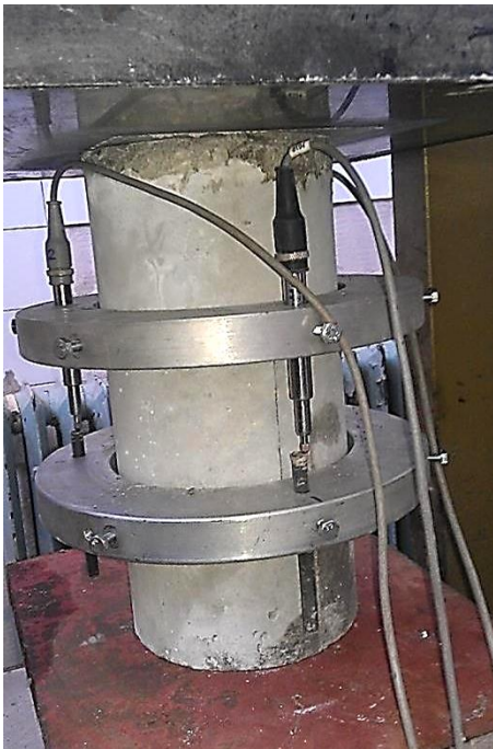
Слика 4.53 – Диспозиција узорка за испитивање односа \sigma - \epsilon
