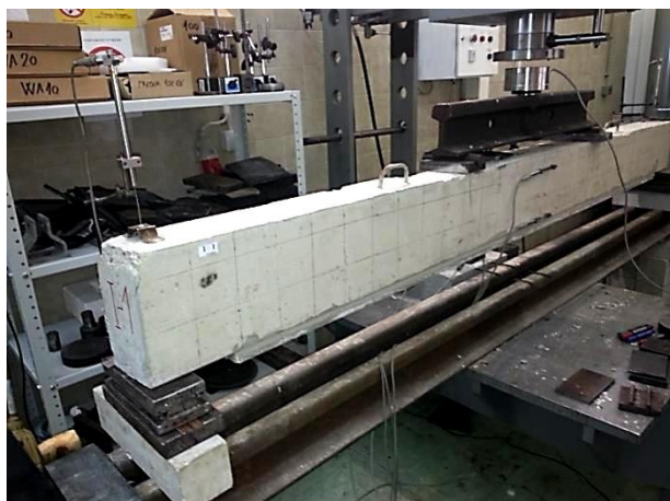
Слика 5.21 – Експериментални модел I-1 пре доношења оптерећења
