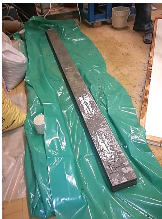
Слика 4.37 – Нега фероцементних елемената влажењем
