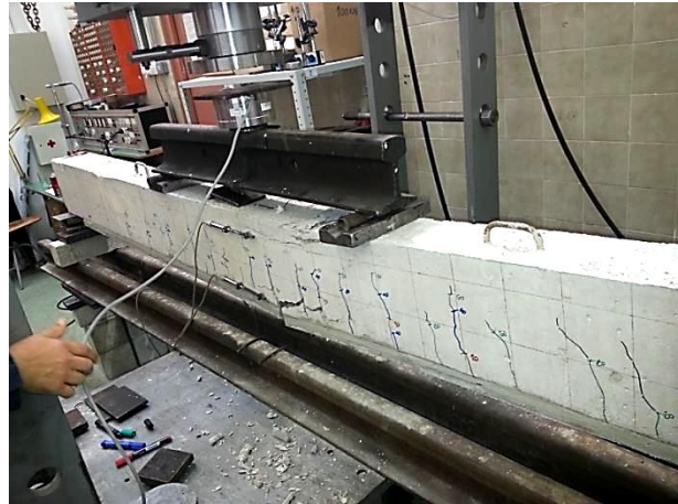
Слика 5.52 – Експериментални модел II-2 након фазе лома
