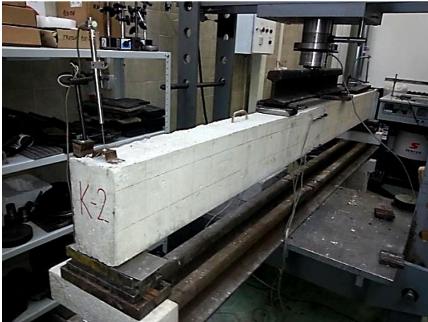
Слика 5.7 – Експериментални модел К-2 пре доношења оптерећења
