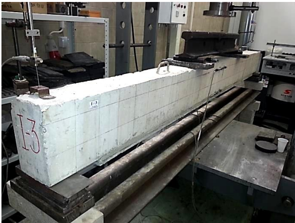
Слика 5.35 – Експериментални модел I-3 пре доношења оптерећења
