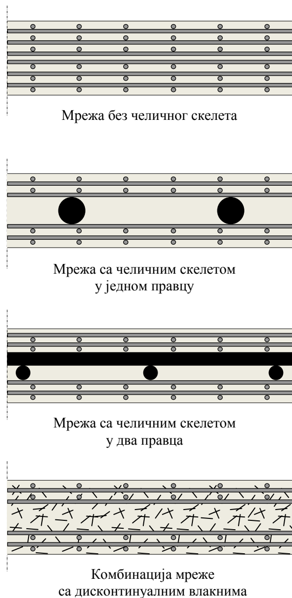
Слика 2.5 – Типични попречни пресеци елемената од фероцемента (Naaman, 2000)
