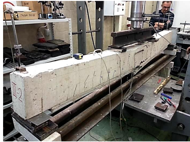
Слика 5.75 – Експериментални модел III-2 након фазе лома
