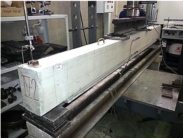
Слика 5.97 – Експериментални модел IV-2 пре наносења оптерећења
