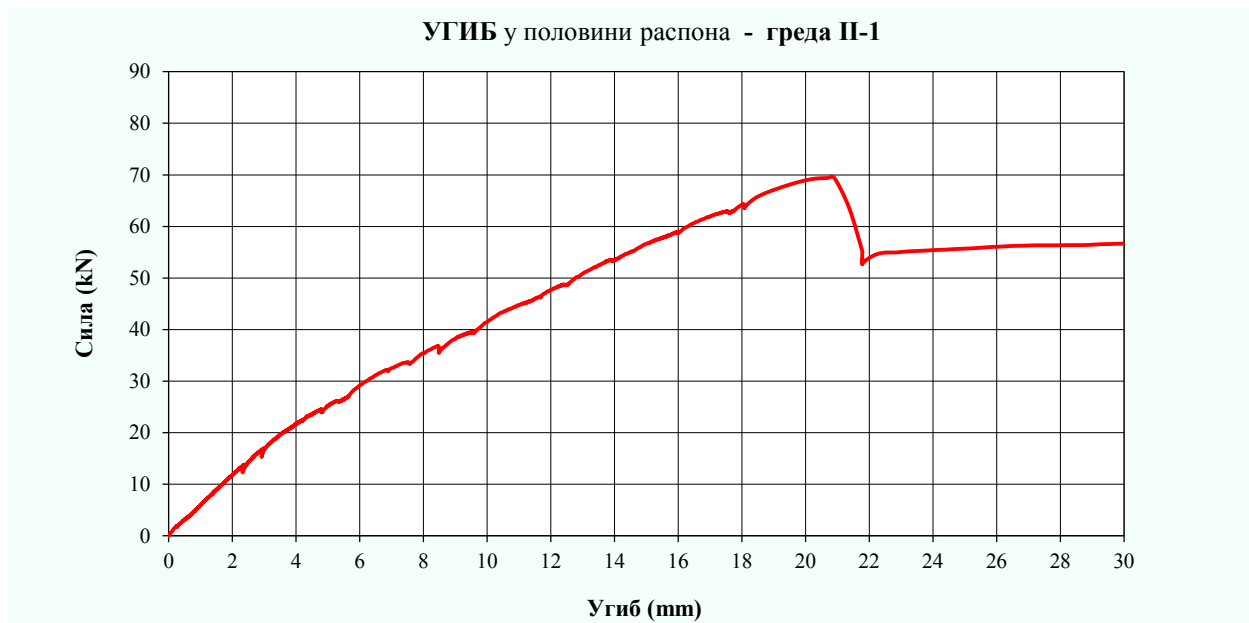
Слика 5.47 – Дијаграм угиба, мерених у половини распона модела II-1
