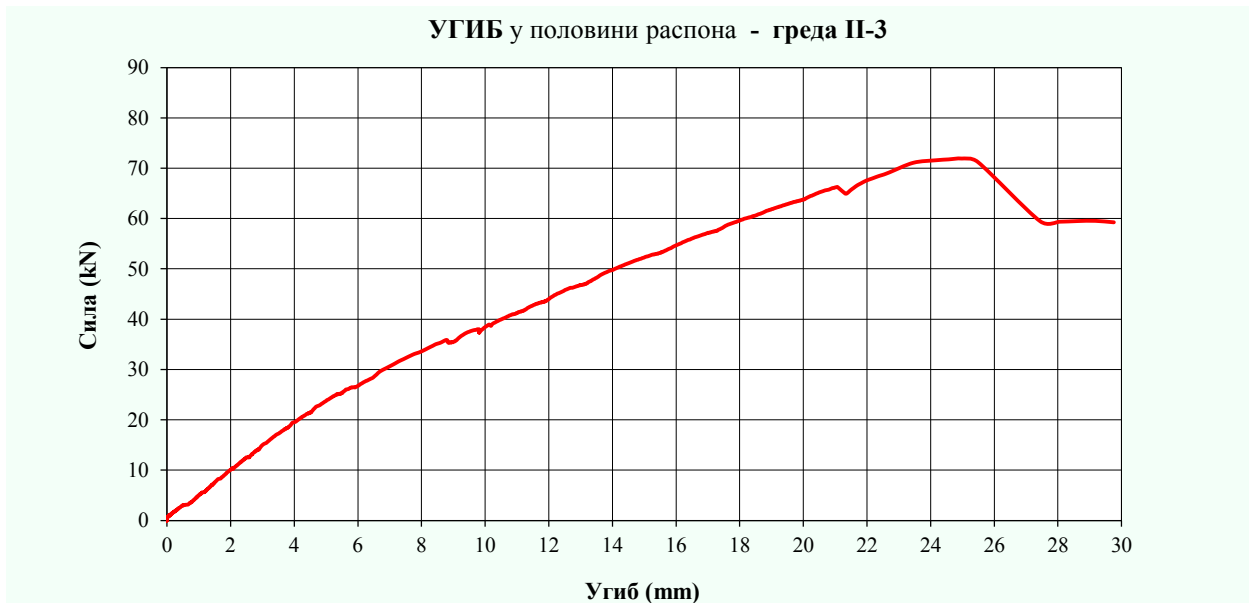
Слика 5.61 – Дијаграм угиба, мерених у половини распона модела II-3
