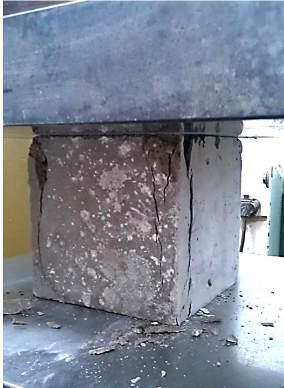
Слика 4.48 – Лом под притиском коцке у преси
