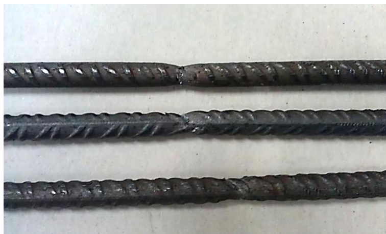
Слика 4.57 – Изглед епрувета након премашене затезне чврстоће (након кидања)
