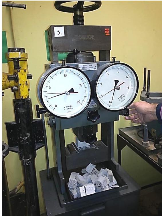
Слика 4.60 – Испитивање узорка у преси на чврстоћу при притиску
