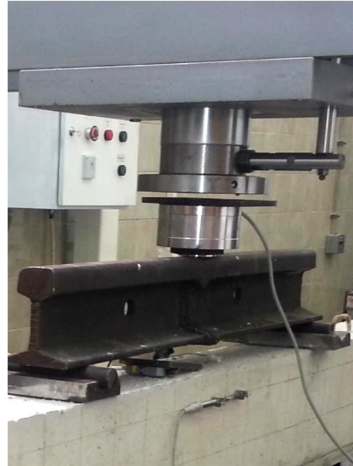
Слика 4.90 – Положај електронског динамометра на експерименталном моделу
