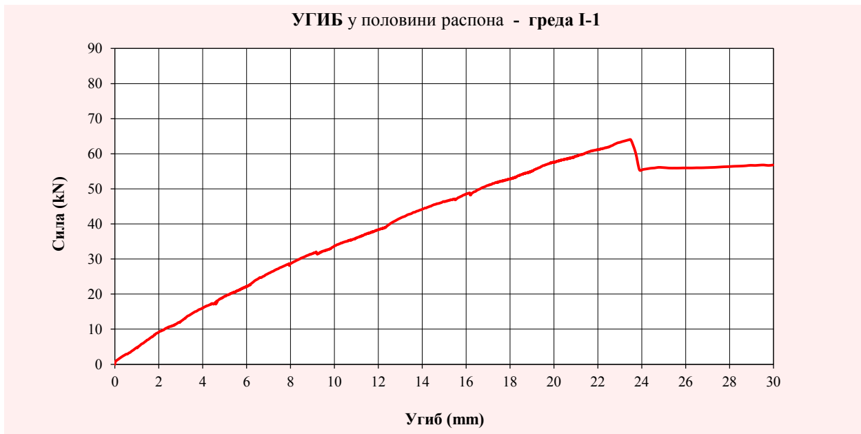
Слика 5.24 – Дијаграм угиба, мерених у половини распона модела I-1
