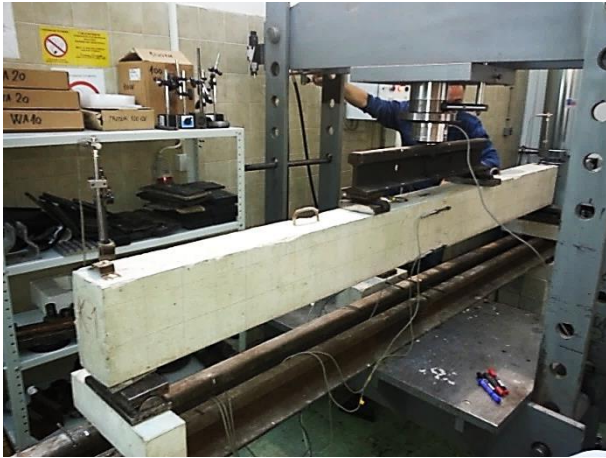
Слика 5.1 – Експериментални модел К-1 пре доношења оптерећења
