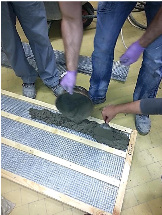
Слика 4.31 – Наношење малтера у оплату
