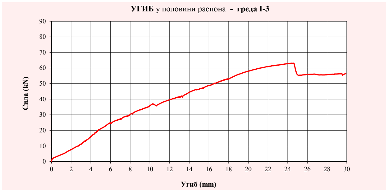
Слика 5.38 – Дијаграм угиба, мерених у половини распона модела I-3
