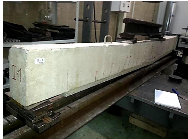
Слика 5.45 – Експериментални модел II-1 након фазе лома
