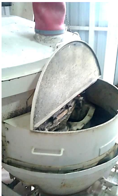
Слика 4.15 – Припрема бетона у мешалици
