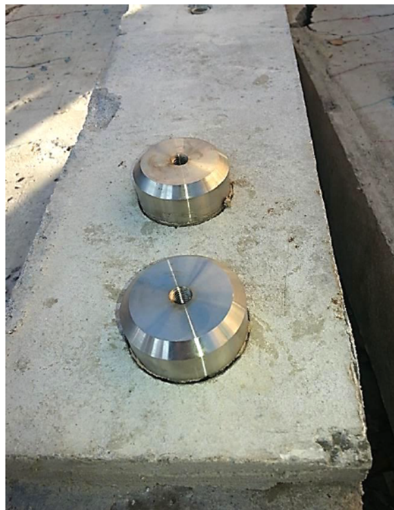
Слика 4.70 – Челични елементи залепљени на узорке ради аплицирања силе чупања
