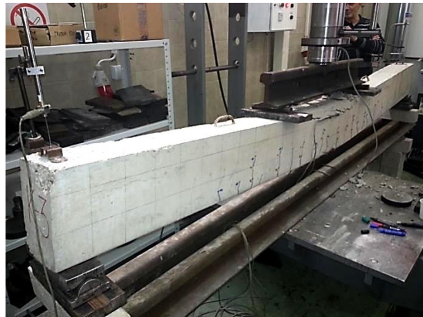
Слика 5.14 – Експериментални модел К-3 након фазе лома
