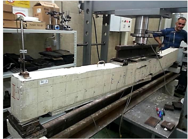
Слика 5.82 – Експериментални модел III-3 након фазе лома
