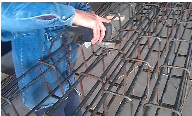
Слика 4.10 – Припрема подужних арматурних профила за постављање мерних трака
