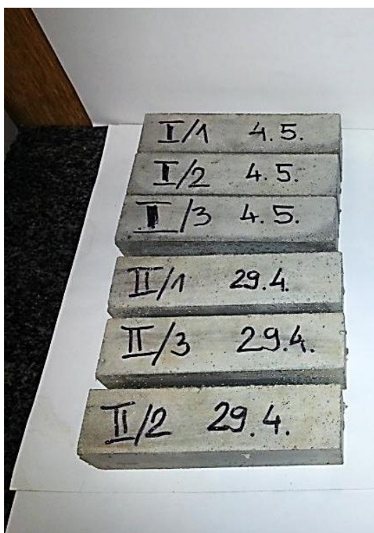
Слика 4.59 – Пробни узорци (епрувете) цементног малтера пре испитивања
