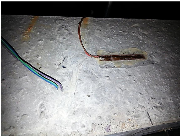
Слика 4.88 – Мерне траке ( l=50\text{mm} ) на бетону
