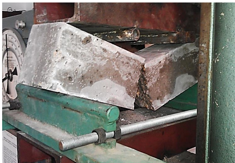
Слика 4.52 – Лом епрувете облика призме након наношења оптерећења
