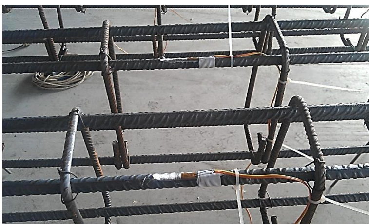
Слика 4.11 – Лепљење мерних трака на арматурне профиле
