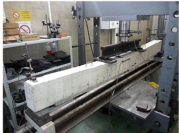
Слика 5.36 – Експериментални модел I-3 након фазе лома
