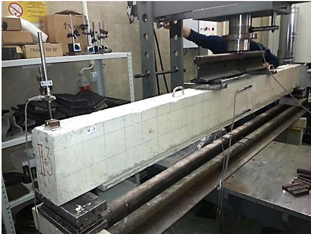
Слика 5.58 – Експериментални модел П-3 пре доношења оптерећења
