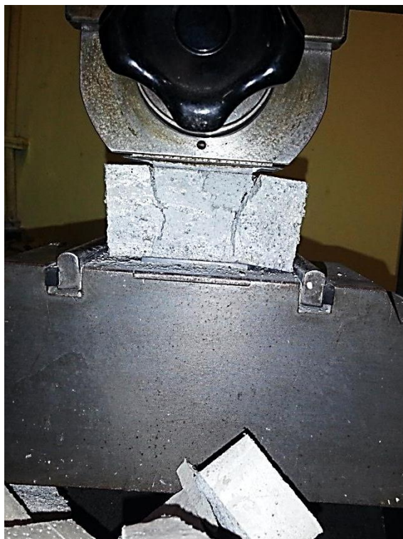
Слика 4.61 – Лом узорка под притиском
