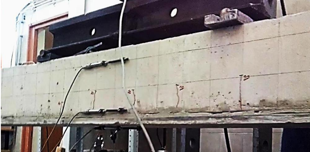
Слика 5.152 – Иницијалне прслине у средњој трећини распона ојачаног модела
