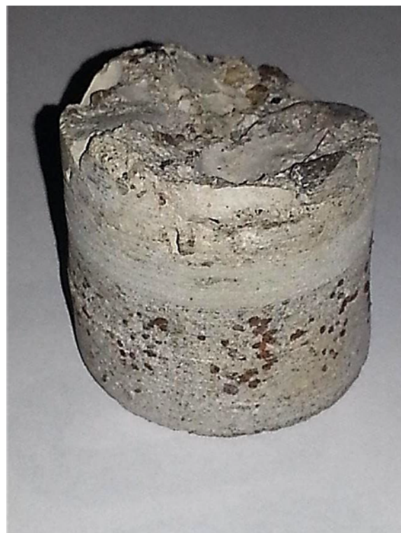
Слика 4.72 – Изглед узорка након чупања, уочљиво одвајање по бетону
