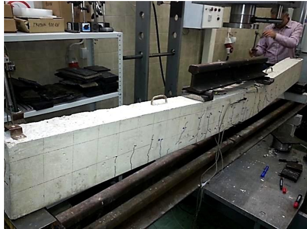
Слика 5.8 – Експериментални модел К-2 након фазе лома
