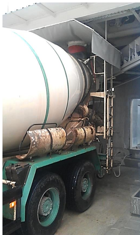
Слика 4.16 – Припрема бетона за транспорт до оплате
