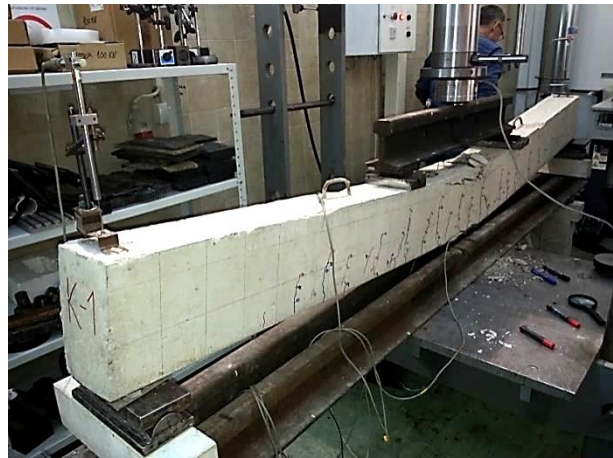
Слика 5.2 – Експериментални модел К-1 након фазе лома
