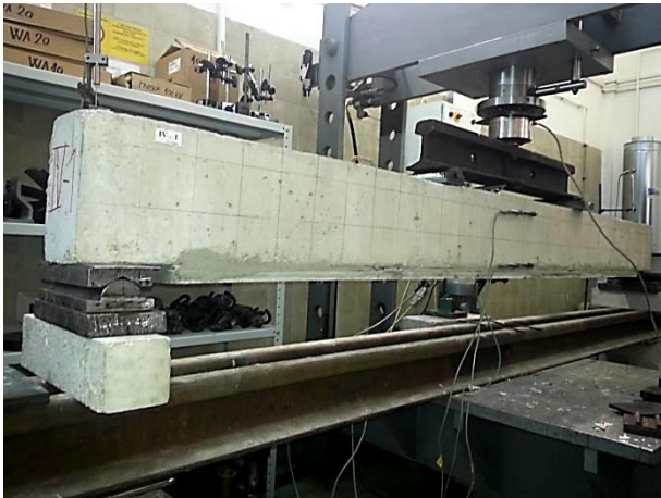
Слика 5.90 – Експериментални модел IV-1 пре доношења оптерећења Слика 5.91 – Експериментални модел IV-1 након фазе лома
