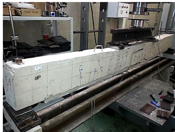
Слика 5.22 – Експериментални модел I-1 након фазе лома
