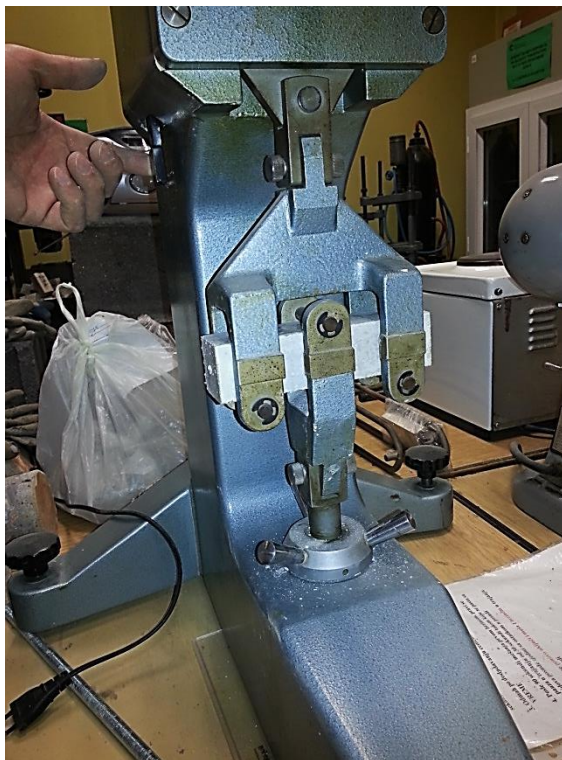
Слика 4.63 – Епрувета облика призме пре наношења оптерећења
