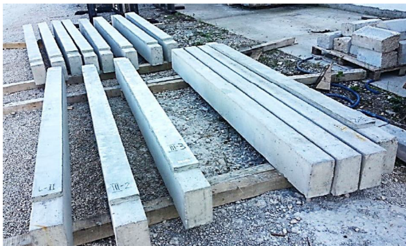
Слика 4.80 – Коначни изглед ојачаних и контролних АБ носача
