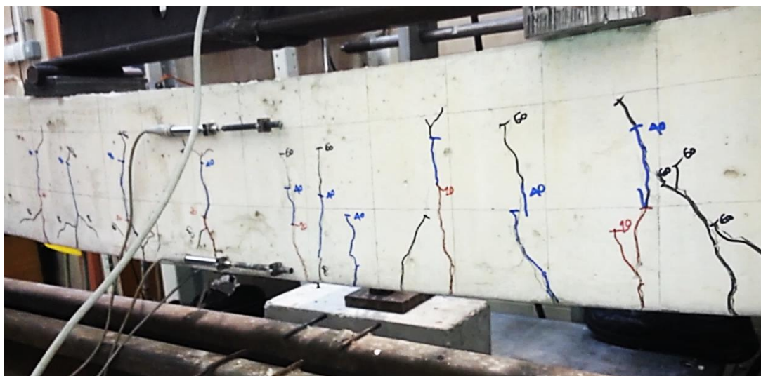
Слика 5.149 – Развој прелина у средњој трећини распона модела типа К
