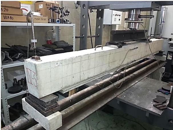
Слика 5.104 – Експериментални модел IV-3 пре доношења оптерећења
