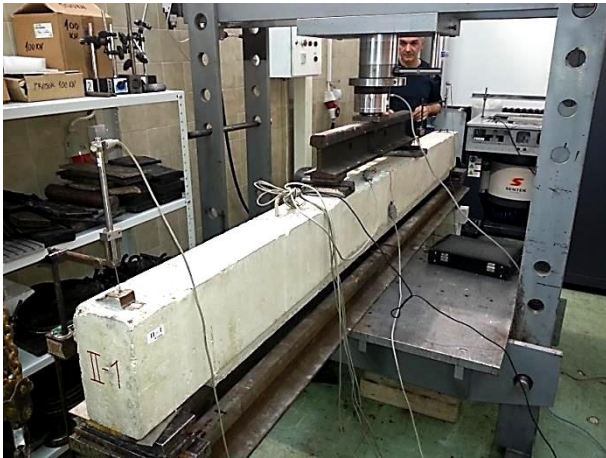
Слика 5.44 – Експериментални модел II-1 пре доношења оптерећења
