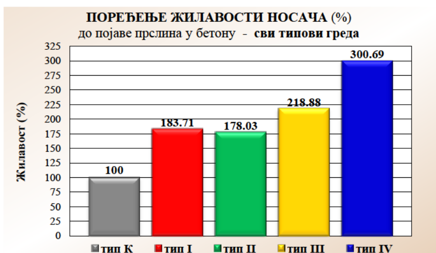
Слика 5.132 – Поређење просечне жилавости свих типова носача до појаве прлина у бетону
