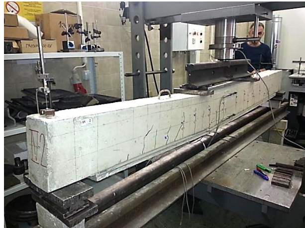
Слика 5.98 – Експериментални модел IV-2 након фазе лома
