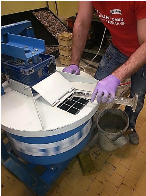
Слика 4.27 – Додатак суперпластификатора
