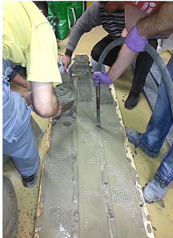
Слика 4.32 – Уградња матрице "утискивањем" уз вибрирање оплате
