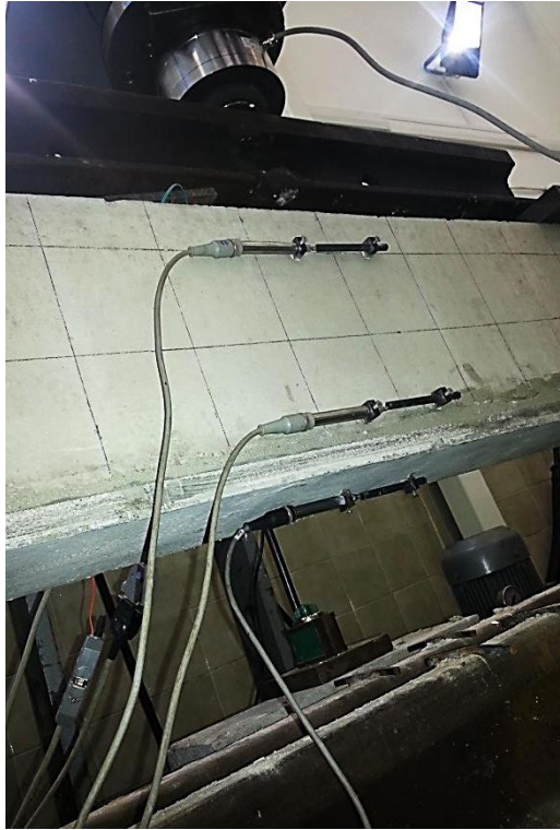
Слика 4.85 – Положај дилатомера D_1 , D_2 , D_3 у половини распона носача
