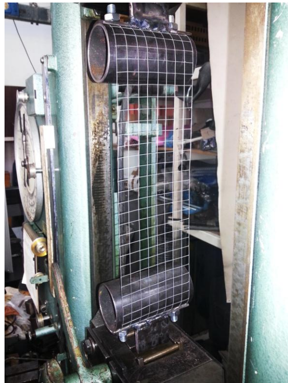
Слика 4.67 – Испитивање узорака рабиц мреже на кидалици
