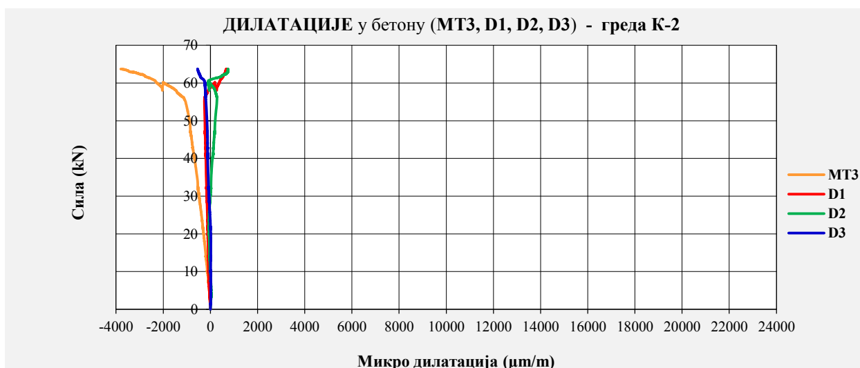
Слика 5.11 – Дилатације у бетону модела К-2, мерене на MT3, D1, D2 и D3
