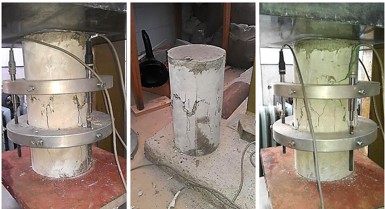
Слика 4.54 – Изглед епрувета након лома под аксијалном силом притиска
