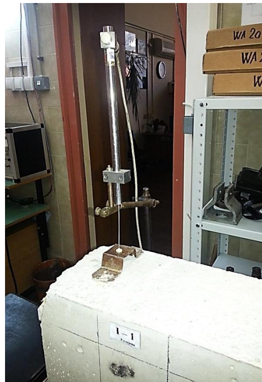
Слика 4.84 – Положај угибомера U_2 ( U_3 ) изнад ослонаца носача
