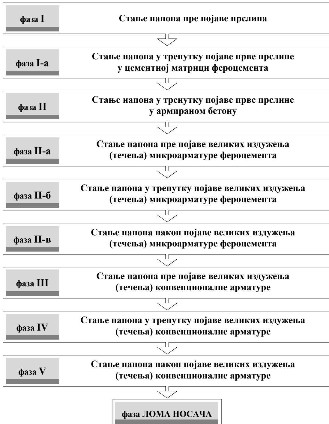
Слика 3.15 – Предвиђена напонска стања ојачане АБ греде
