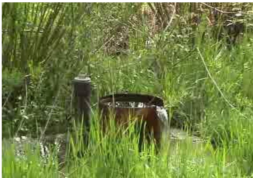
Slika 5.8 Snimak bunara CB 41 u trenutku izlivanja podzemnih voda (Krnjača, april 2004.)
