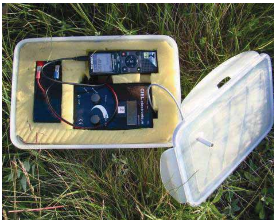
Slika 30. Pribor i uređaji za automatsku stacionarnu ultrazvučnu detekciju slepih miševa. Fotografija Vukašin Josipović, 2015.
