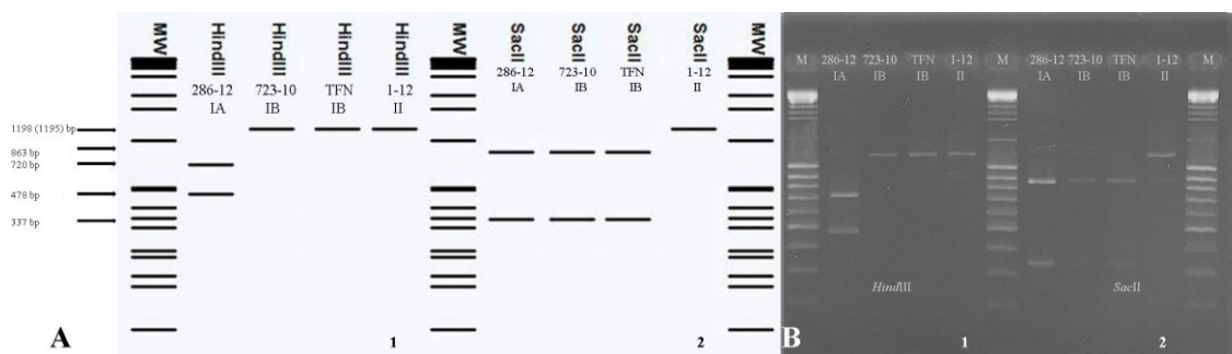
Slika 53. „ In silico “ (A) i „ in situ “ (B) restrikcioni profili izolata 286-12, 723-10, TFN i 1-12 CMV, amplifikovani specifičnim parom prajmera RNA1a-fwd/ RNA1a-rev koji omogućavaju deo 1a gena ukupne veličine od 1198 bp, nakon digestije restrikcionim enzimima Hind III (1) i Sac II (2).
