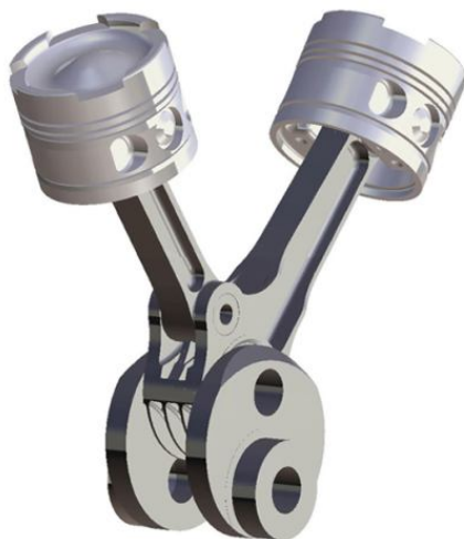
Slika 3.3 – Virtuelni model jednog karakterističnog odsečka klipnog mehanizma
