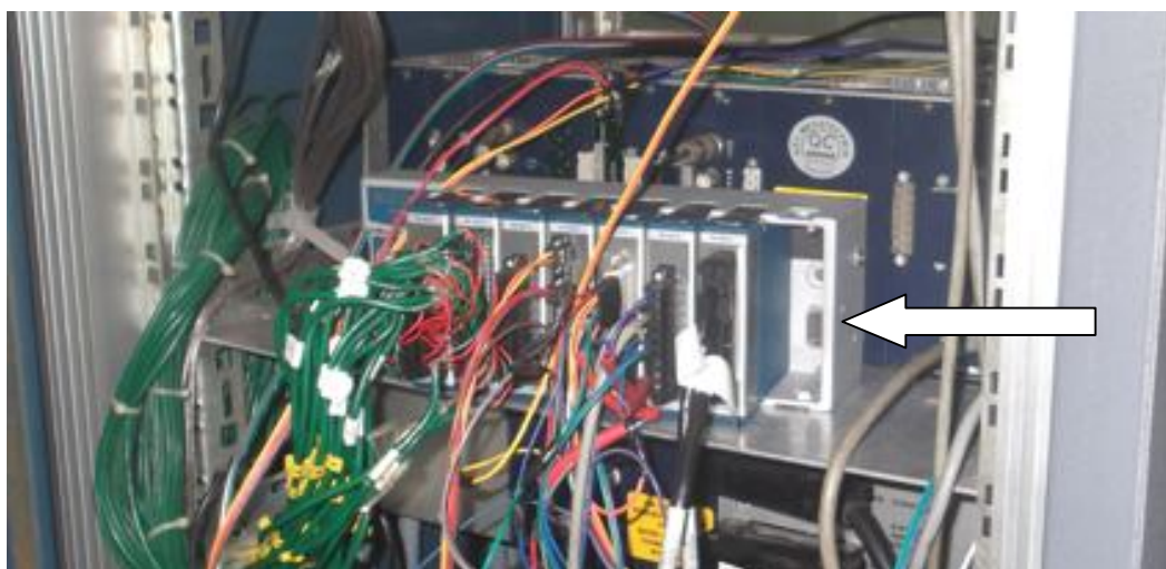
Slika 2.7 – Uređaj CompactDAQ-9178 proizvođača National Instruments
