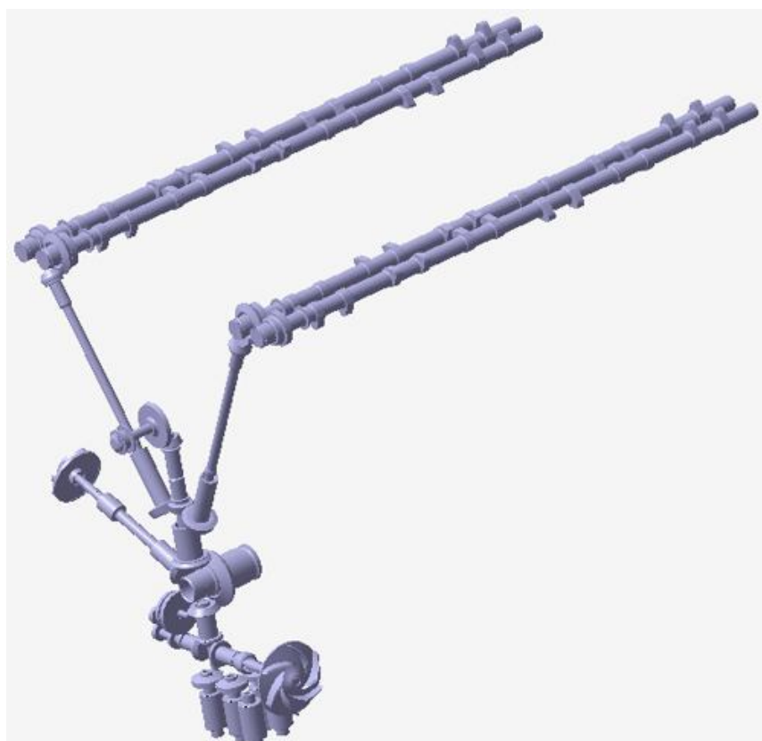
Slika 7.8 – Virtualni model sistema vitkih vratila i koničnih zupčanika preko kojih se pokreću svi vitalni motorski podsistemi osim pumpe visokog pritiska
