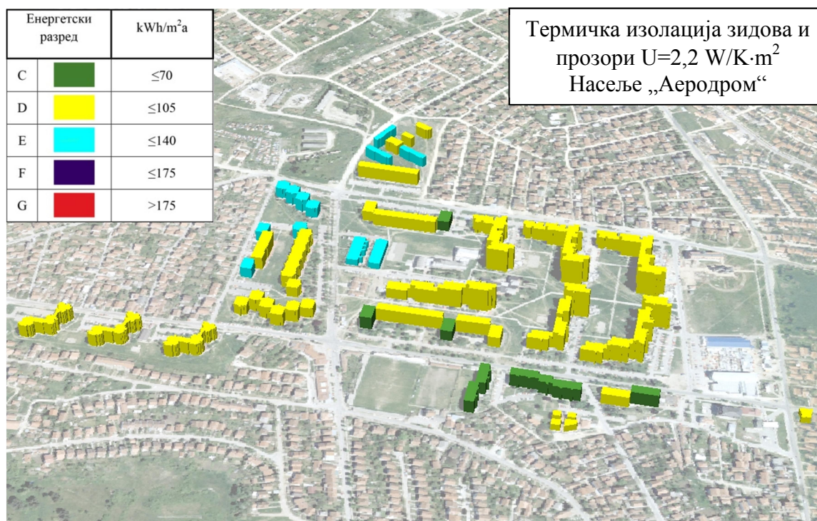
Слика 5.11 Енергетска мапа процењене годишње специфичне потрошње енергије за грејање вишепородичних стамбених зграда у насељу „Аеродром“ у граду Крагујевцу, после уградње термичке изолације дебљине 10 cm на спољашње зидове и прозора са коефицијентом пролаза топлоте U=2,2 \text{ W/K}\cdot\text{m}^2
